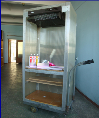
Пересувний лабораторний стэнд, що дозволяє при контролі створювати необхідне освітлення робочого місця та фільтрувати повітря робочої зони
