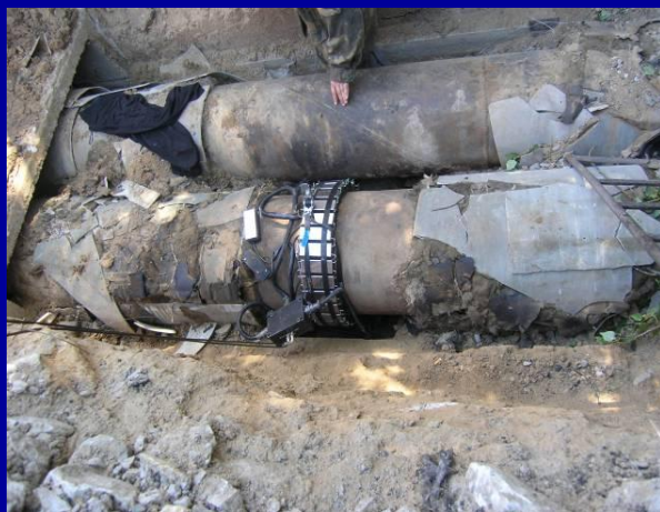
Контроль підземної ділянки діючої теплотраси (труба Ø430 мм з товщиною стінки 8 мм) з корозійним ураженням
