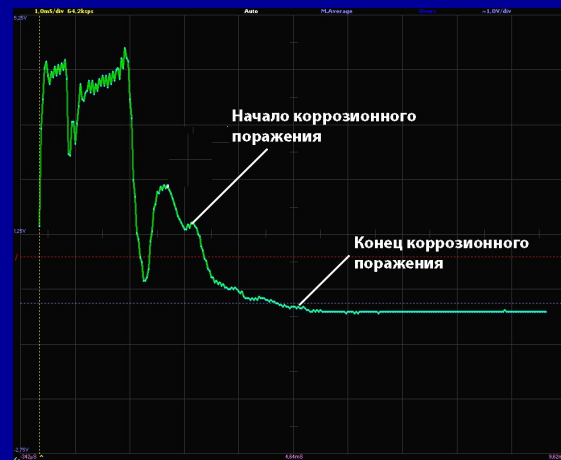
Контроль підземної ділянки діючої теплотраси (труба Ø430 мм з товщиною стінки 8 мм) з корозійним ураженням
