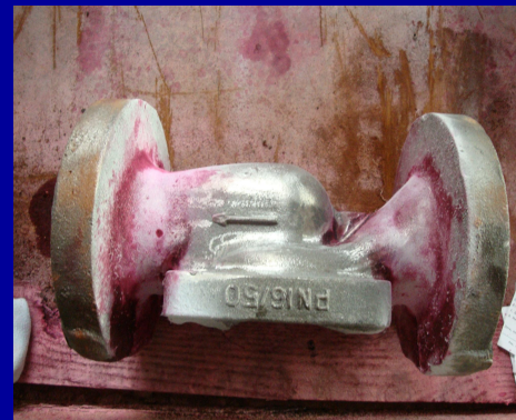
Капілярний контроль сталевого литва корпусів запірної арматури на Миргородському заводі «Армапром»
