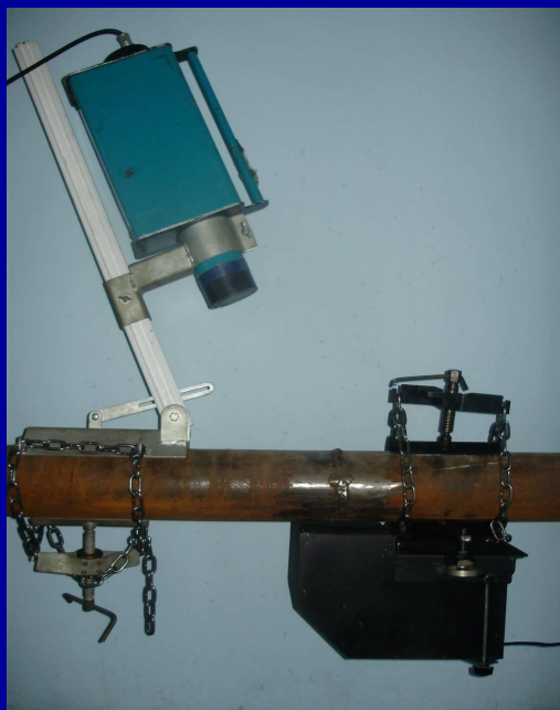
Контроль технологічного трубопроводу Ø114 мм цифровою системою на основі телевізійної камери Atik 314L та імпульс- ного рентгенівського апарату МИРА-2Д
