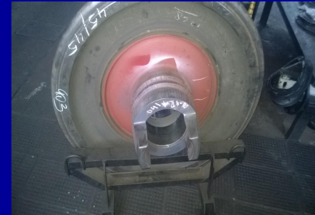
Капілярний контроль силових вузлів розсувних колісних пар системи SUW-2000 (повідкові центри) в ДП «Пасажирське вагонне депо Львів»
