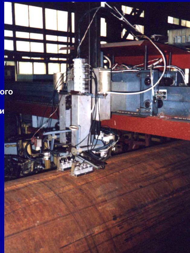
Установка НК-205 для автоматизованого УЗК труб великого діаметру
