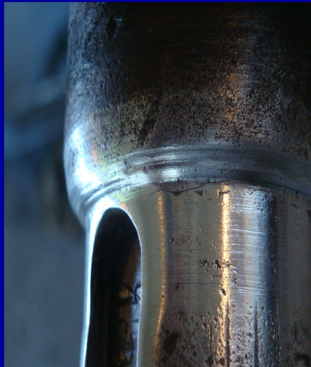
Контроль валу електрогенератора пасажирського вагону
