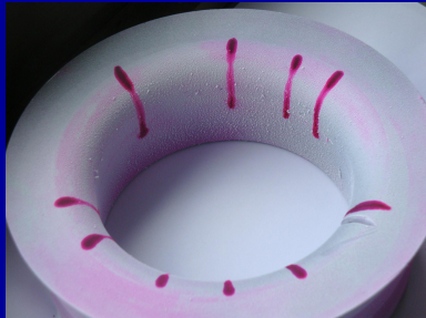
Індикаторні сліди тріщин втоми в наплавленому шарі фільтри для формування сталевих трубок
