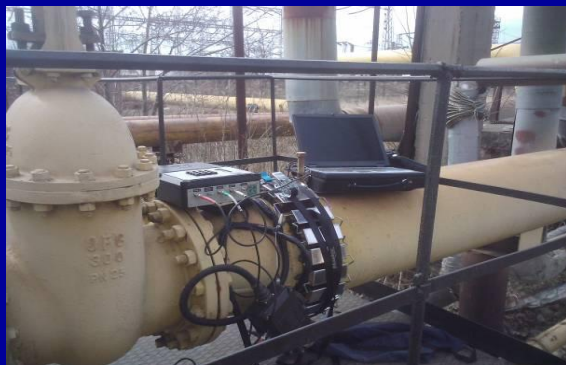
Контроль наземної ділянки газопроводу протяжністю 150 м, Ø330 мм, з товщиною стінки 8 мм
