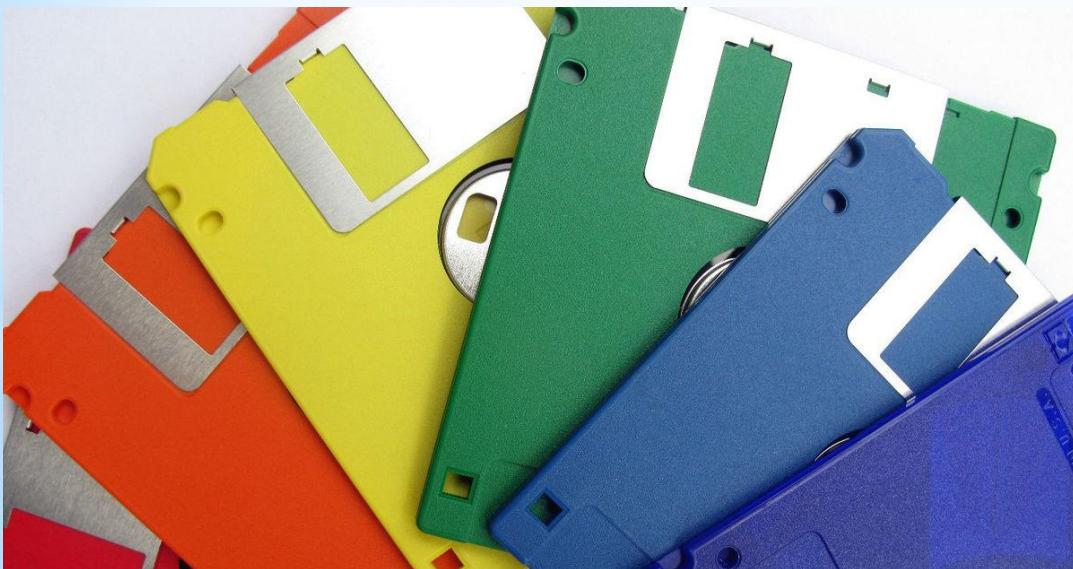
Гибкие магнитные диски помещаются в пластмассовый корпус. В центре дискеты имеется приспособление для захвата и обеспечения вращения диска внутри пластмассового корпуса.
