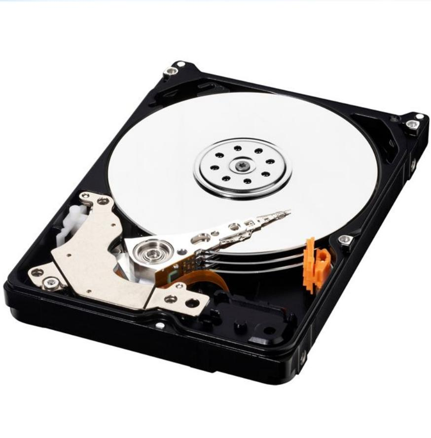
Прочный металлический корпус полностью герметичен и защищает дисковод от частичек пыли. Корпус экранирует накопитель от электромагнитных помех. Диск представляет собой круглую пластину с очень ровной поверхностью чаще из алюминия, реже - из керамики или стекла, покрытую тонким ферромагнитным слоем.
