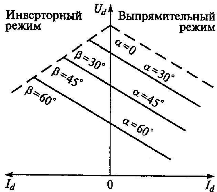
Входные и ограничительная характеристики инвертора при \omega L_d = \infty
