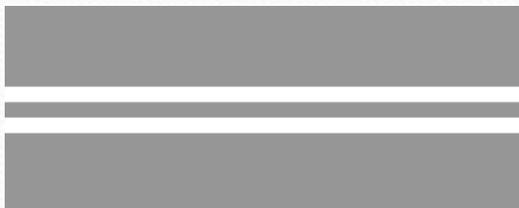
**1.3** - разделяет транспортные потоки противоположных направлений на дорогах, имеющих четыре полосы движения и более;
