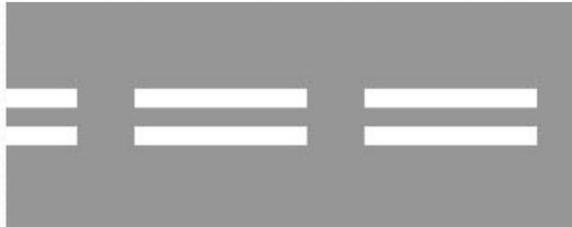
**1.9** обозначает границы полос движения, на которых осуществляется реверсивное регулирование; разделяет транспортные потоки противоположных направлений (при выключенных реверсивных светофорах) на дорогах, где осуществляется реверсивное регулирование;
