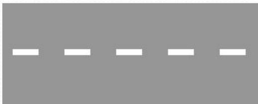
**1.5** - разделяет транспортные потоки противоположных направлений на дорогах, имеющих две или три полосы; обозначает границы полос движения при наличии двух и более полос, предназначенных для движения в одном направлении;
