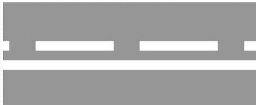
**1.11** разделяет транспортные потоки противоположных или попутных направлений на участках дорог, где перестроение разрешено только из одной полосы; обозначает места, предназначенные для разворота, въезда и выезда со стояночных площадок и тому подобного, где движение разрешено только в одну сторону;
