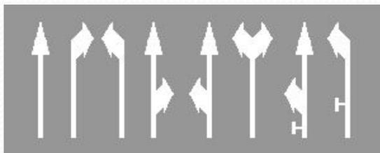
**1.18** - указывает разрешенные на перекрестке направления движения по полосам. Применяется самостоятельно или в сочетании со знаками **5.8.1**, **5.8.2**; разметка с изображением тупика наносится для указания того, что поворот на ближайшую проезжую часть запрещен; разметка, разрешающая поворот налево из крайней левой полосы, разрешает и разворот;
