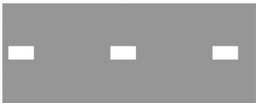
**1.8** (широкая прерывистая линия) - обозначает границу между полосой разгона или торможения и основной полосой проезжей части (на перекрестках, пересечениях дорог на разных уровнях, в зоне автобусных остановок и тому подобное);
