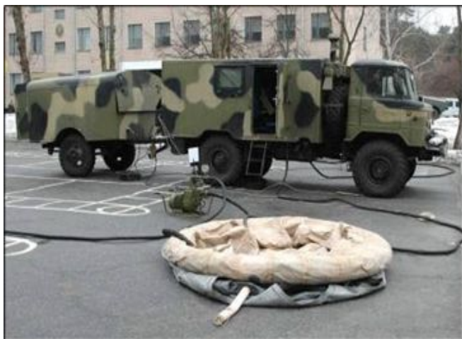
Військова фільтраційна станція ВФС-2,5
