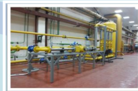
Эталонная установка ЭУ-4 единицы расхода газа при давлении до 1,1 МПа
