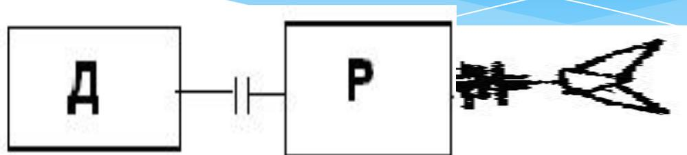
Если дизель является приводом электрогенератора, то такая установка называется *дизель-генератором*
