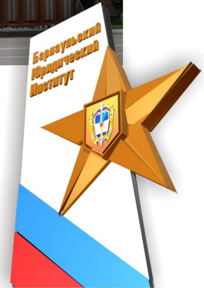
Вариант декоративного оформления существующей стелы (крыло самолета). В объеме выполняются звезда с символикой БЮИ и аббревиатура "БЮИ". Материал: оцинкованная сталь. Флаг - пленочная аппликация.
