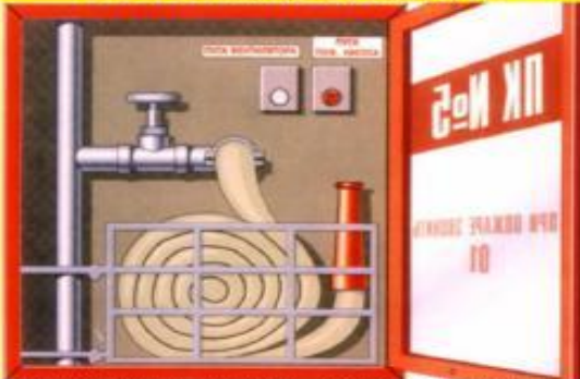
ВНУТРЕННИЙ ПОЖАРНЫЙ КРАН
