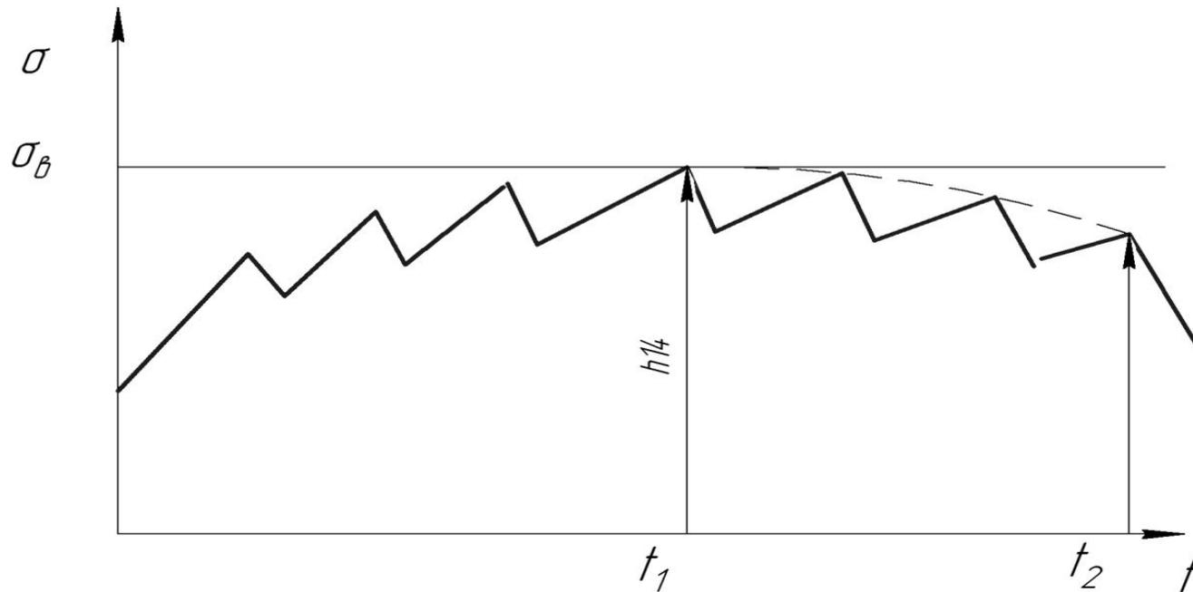
$t_1$  - момент времени внезапного отказа, связанного с перегрузкой.
