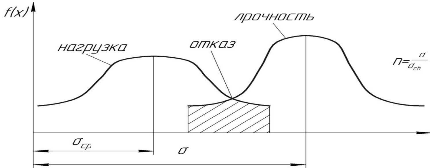
Зона внезапных отказов при расчетном коэффициенте запаса прочности (на рисунке заштрихована)
