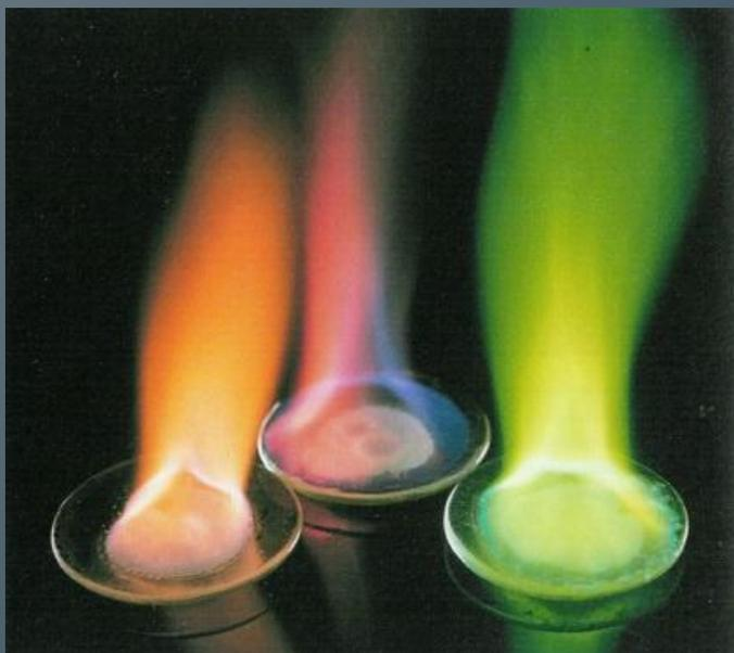
Он вводил в пламя газовой горелки источник паров натрия (металлический натрий в маленьком тигле) или асбест, смоченный раствором поваренной соли. Пламя горелки при этом приобретало характерную желтую окраску, соответствующую излучению паров натрия
