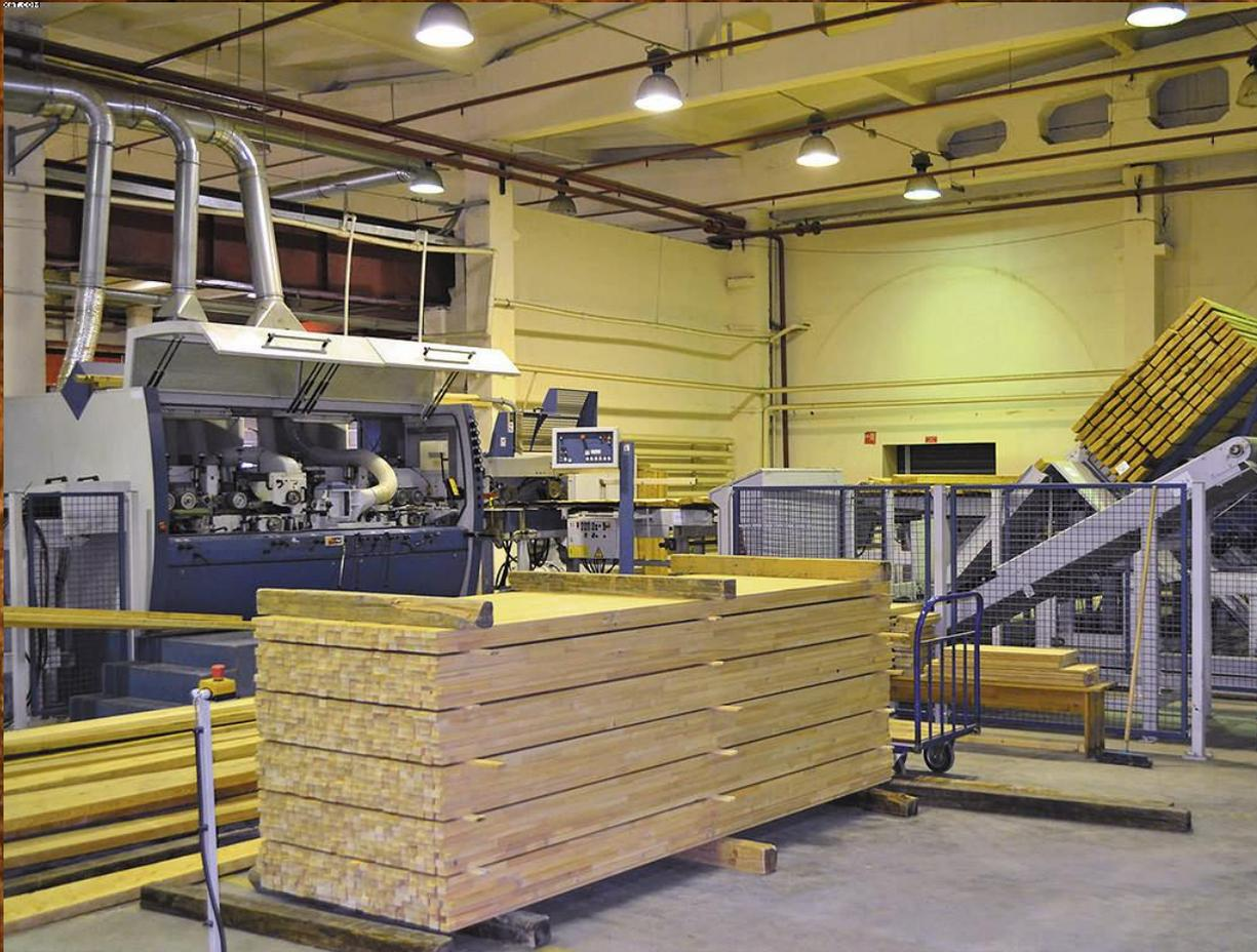
Обработку древесины на заводе ведут в определенной последовательности, технологический процесс начинается с раскряса древесины (бревен, брусков, досок и др.), т. е. с распиловки, просушки, строгания, придают изготавливаемым элементам необходимую форму.
