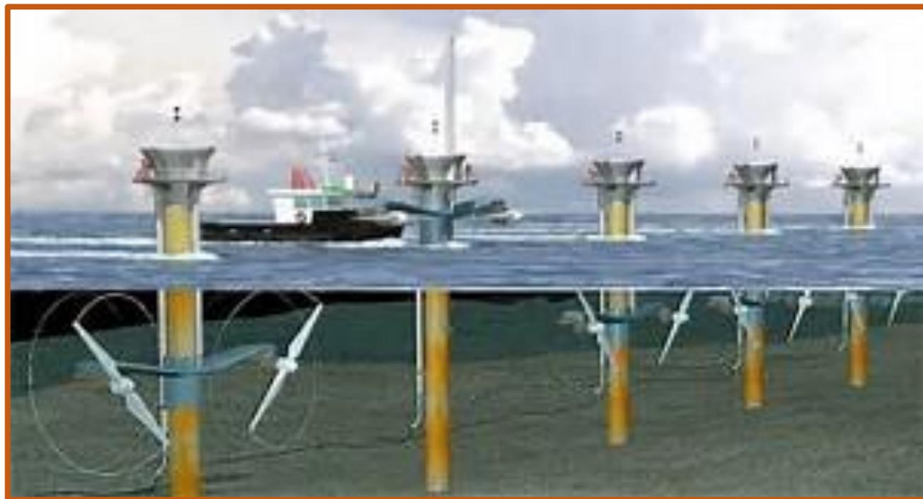
Приливная электростанция (ПЭС) - особый вид гидроэлектростанции, использующий энергию приливов, а фактически кинетическую энергию вращения Земли. Приливные электростанции строят на берегах морей, где гравитационные силы Луны и Солнца дважды в сутки изменяют уровень воды. Колебания уровня воды у берега могут достигать 18 метров.
