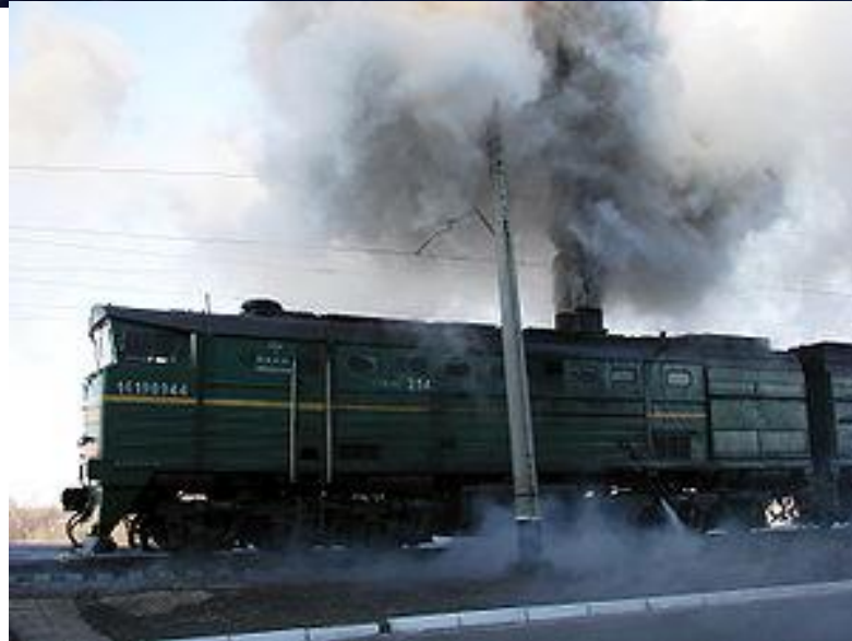
Загрязнение атмосферы тепловозом 2ТЭ10М
