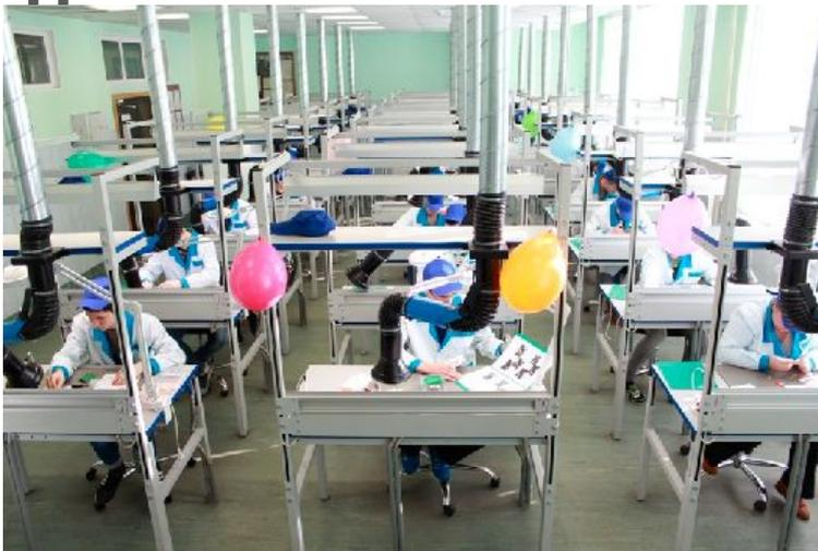
Монтажник устанавливает навесные радиодетали на платах (специальные схемы с обозначенными местами креплений деталей и расположения проводов), производит узловую сборку и электрический монтаж по монтажным и принципиальным схемам, осуществляет сборку узлов на шасси и межузловой электрический монтаж, используя при этом пайку, приклеивание, проволочный и печатный монтаж.
