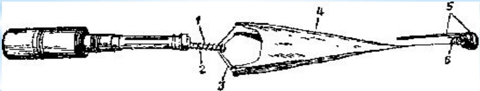
Рис. 4. Граната во время полета: 1-пружина стабилизатора; 2-подвижная трубка; 3 — проволоочные перья, 4 - матерчатый конус, 5 -откидной колпак с планкой, 6 - пружина колпака.
