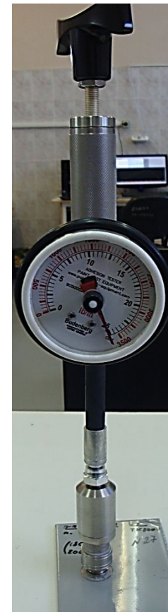
- Адгезия покрытия к стали - адгезиметр гидравлический Paint Test X1003, ELCOMETER 508
