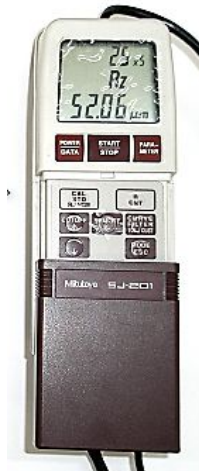
- Шероховатость поверхности (Rz) профилометр Mitutoyo SJ-201
