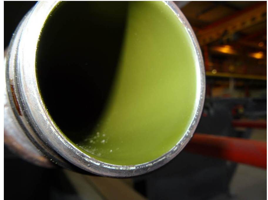
Нанесение Защитного слоя (Порошковая краска (новолак))
