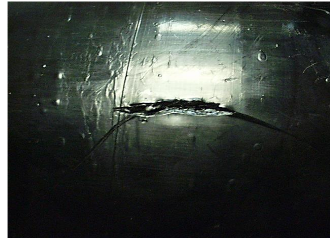
Сквозное повреждение покрытия
