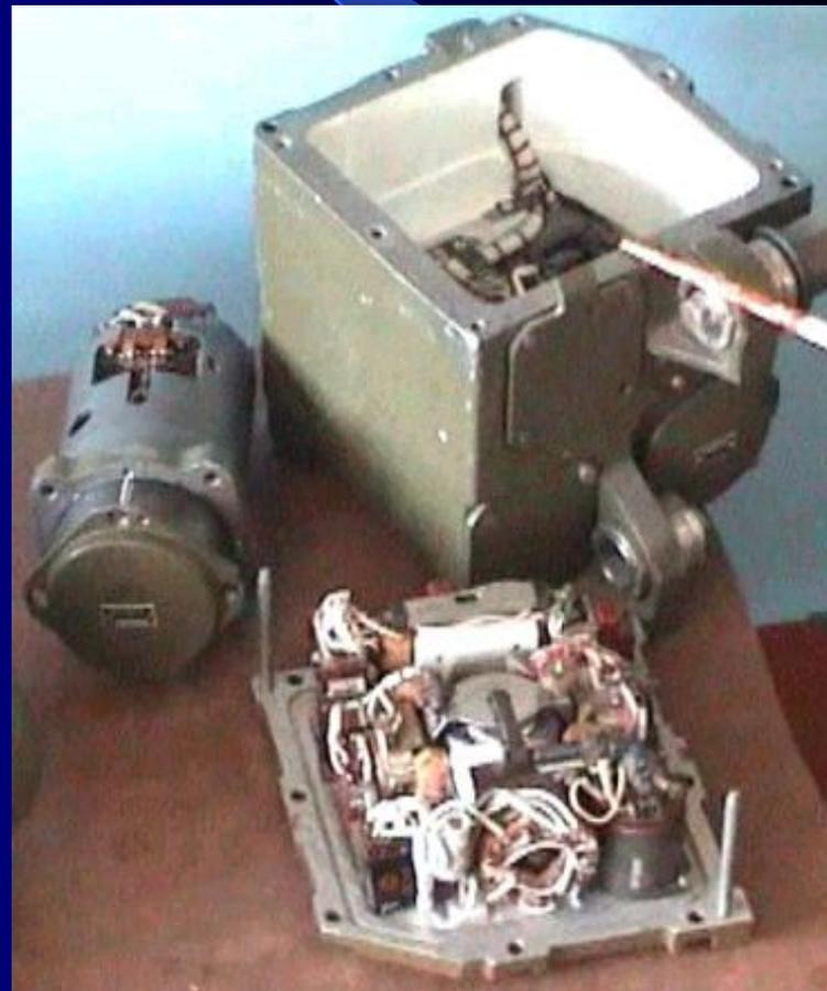
**Преобразователь (П)** предназначен для преобразования постоянного тока БС 26В в переменное напряжение 36В частотой 500Гц, который служит для питания гиromоторов, трансформаторов и других элементов.
