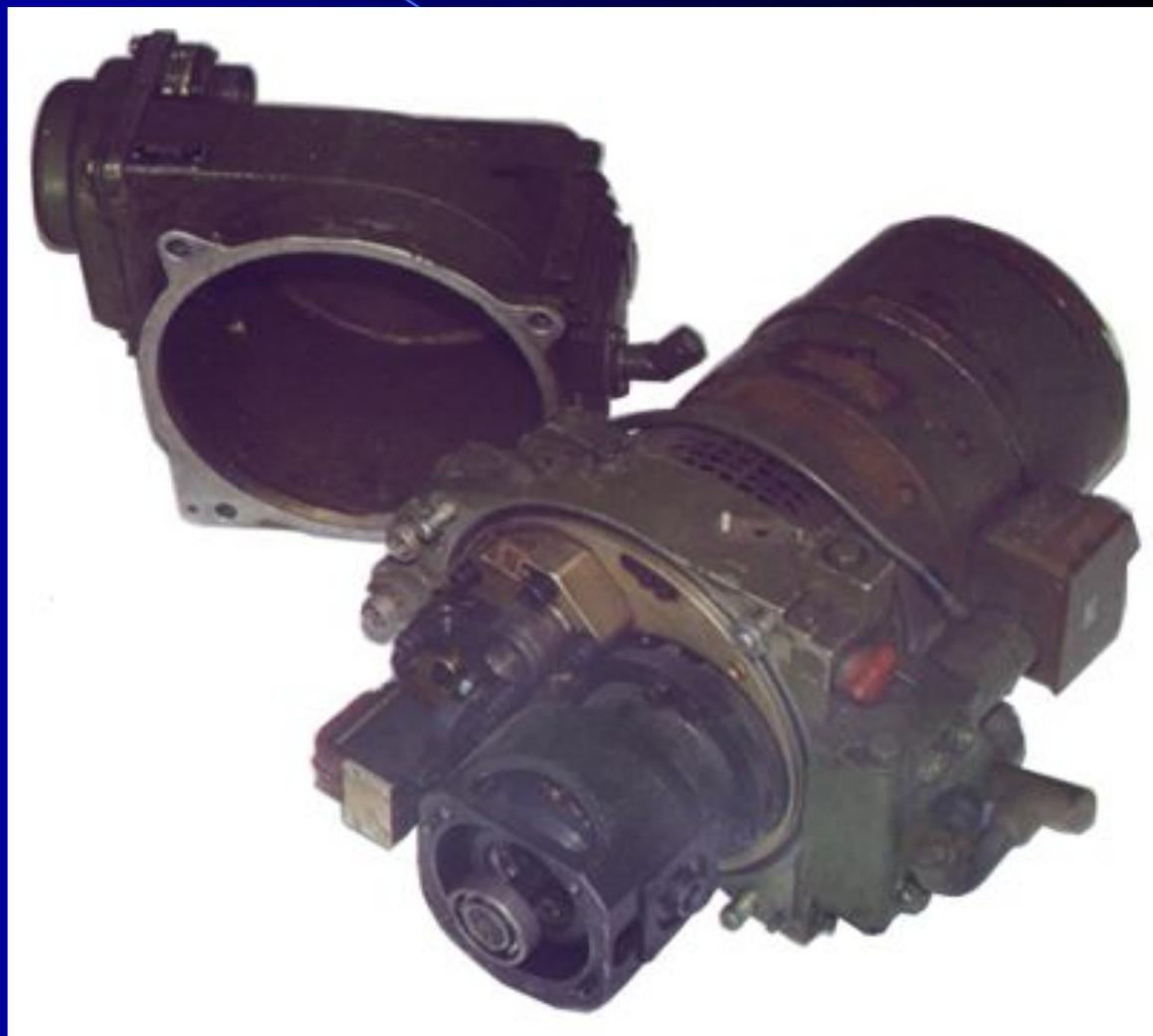
**Гидромотор большого момента (ГБМ)** преобразует энергию рабочей жидкости в механическую энергию выходного вала.
