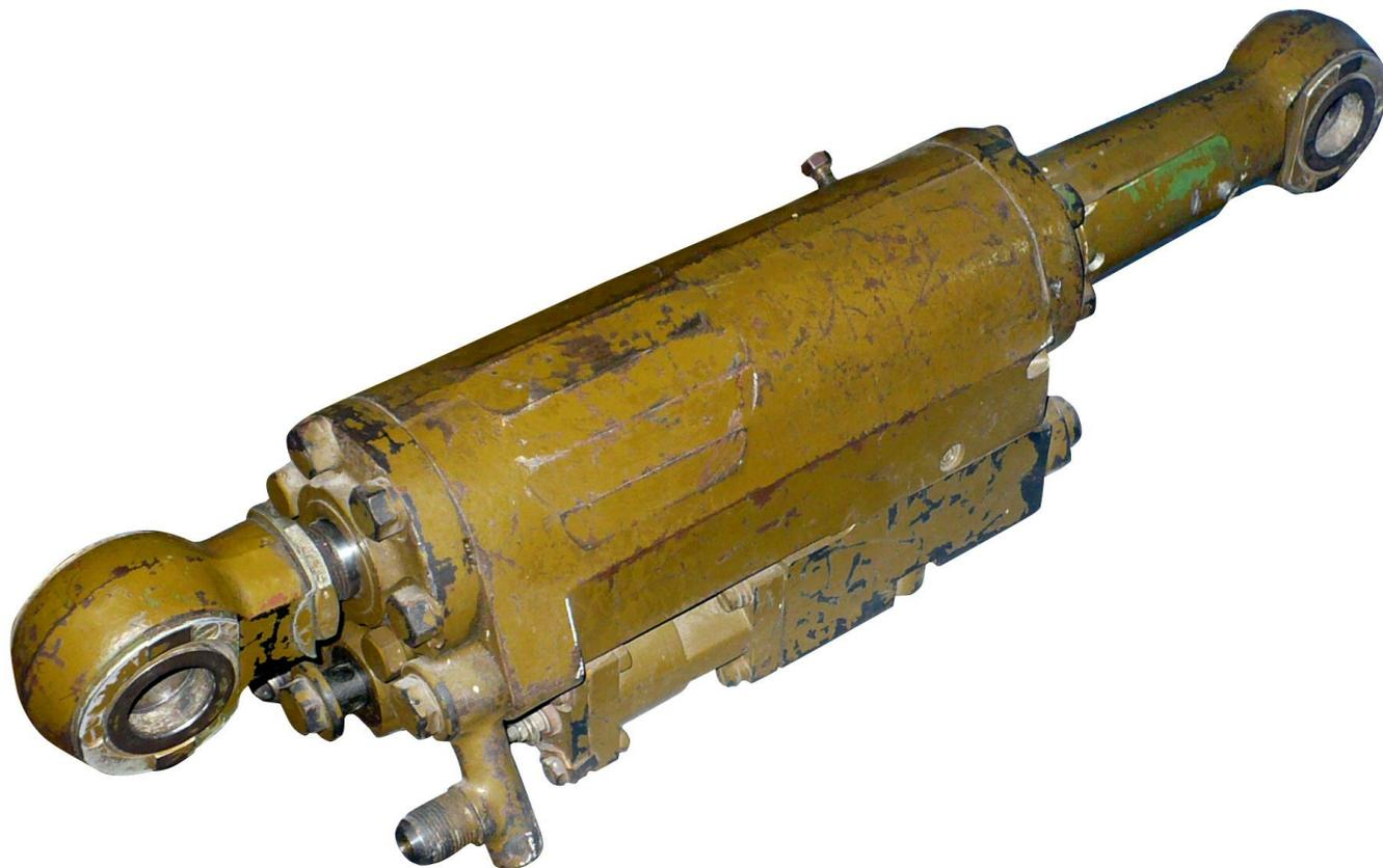
**Прибор приведения (ПП)** предназначен для приведения пушки к углу заряжания и удержания ее на этом угле на период заряжания.
