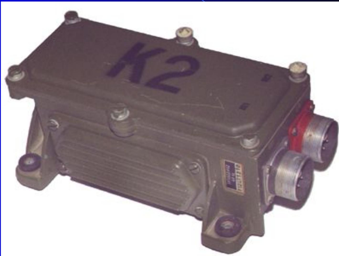
**Датчик линейных ускорений (ДЛУ)** предназначен для измерения ускорений, действующих в плоскости погона башни в направлении, параллельном оси цапф, и для выработки пропорционального электрического сигнала.
