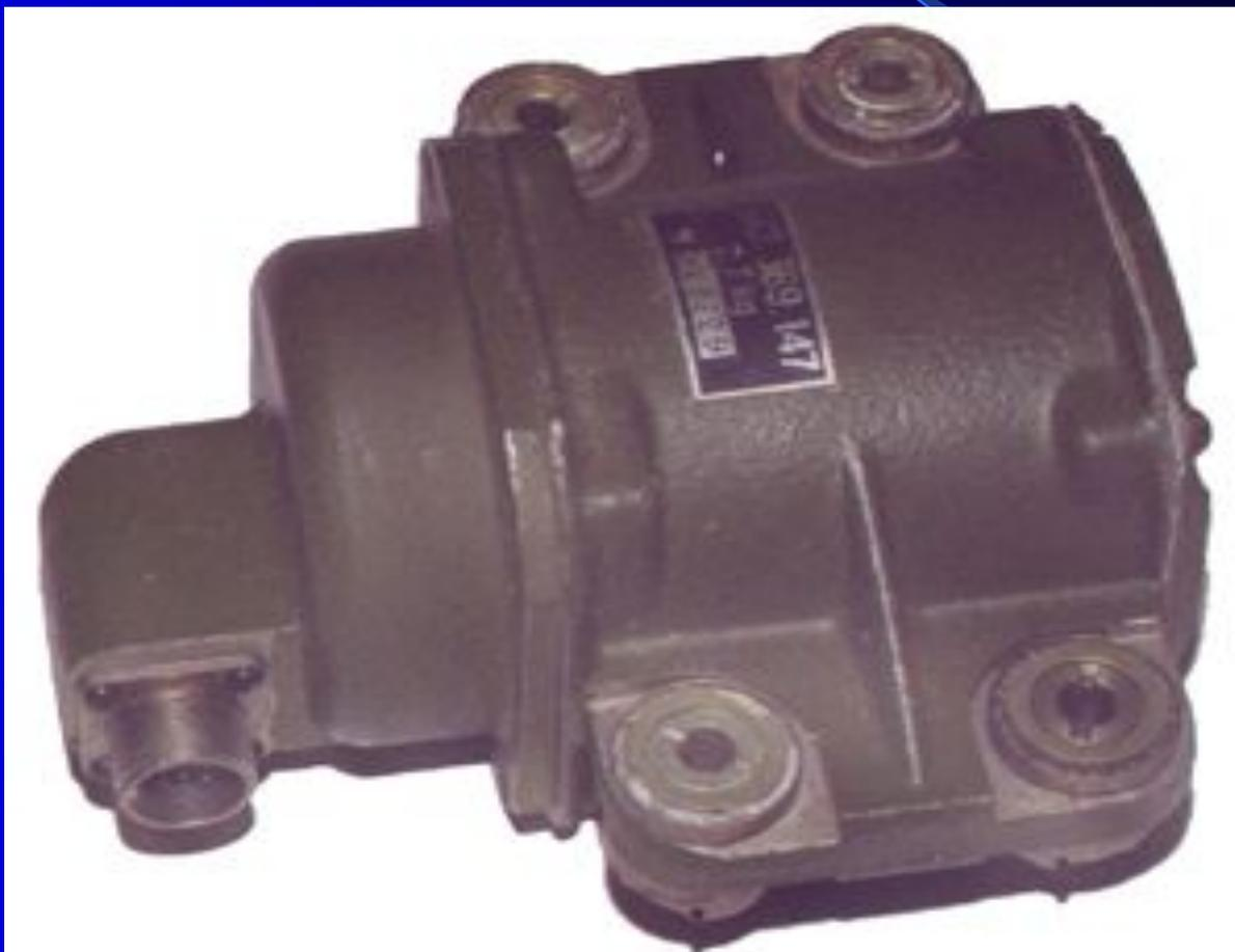
**Два индуктивных датчика (ИДС)** предназначены для измерения давления в рабочих полостях ГБМ и выработки сигнала, пропорционального давлению. Введение этого сигнала улучшает качество работы привода ГН, устраняет вибрацию и повышает точность системы.
