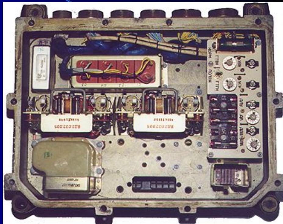
**Гироскоп (ГБ)** предназначен для размещения электрогироскопических приборов, предназначенных: для изменения углового отклонения пушки от заданного стабилизированного положения и для наведения пушки в горизонтальной плоскости; для измерения абсолютных угловых скоростей перемещения пушки в вертикальной и горизонтальной плоскостях; для преобразования этих величин в пропорциональные по величине и соответствующие по фазе сигналы.
