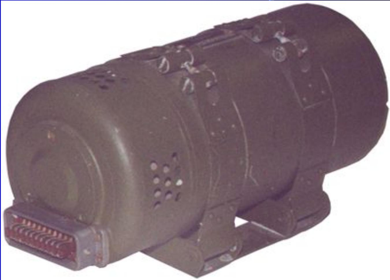
**Стабилизатор частоты (СЧ)** - прибор, поддерживающий постоянную скорость вращения приводного электродвигателя, стабилизируя, тем самым частоту выходного напряжения генератора преобразователя.
