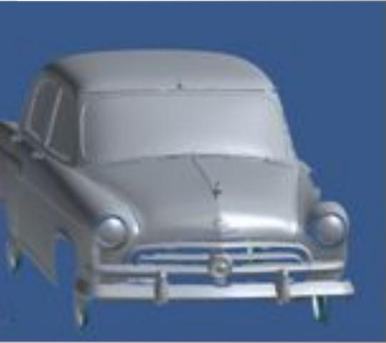
Рис. 35 Оцифрованные модели с помощью системы ATOS III
