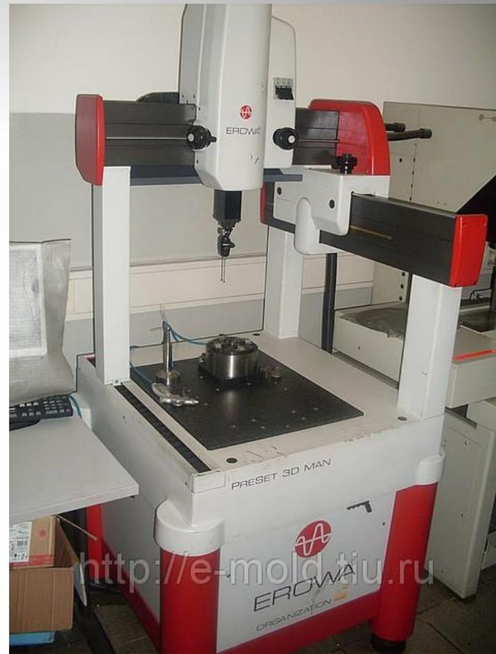
Рис. 33б Контрольно измерительная машина
