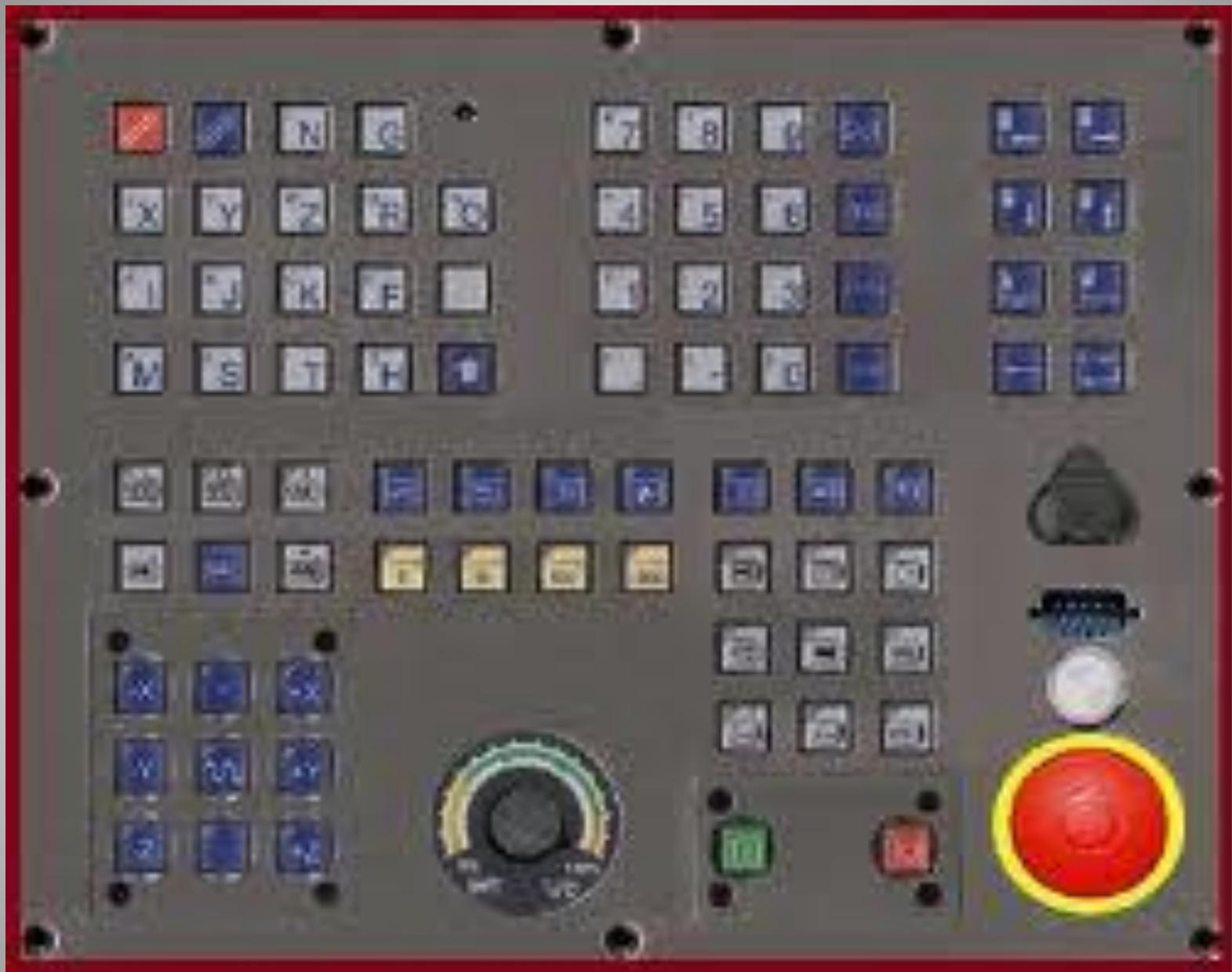
Рис. 37 Пульт управления станком с ЧПУ
