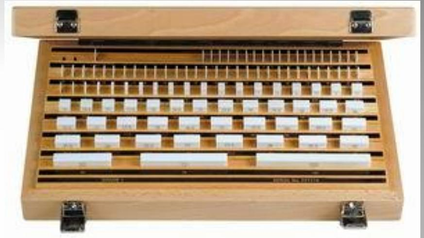
Рис. 22 Резьбовой калибр, концевые меры длины
