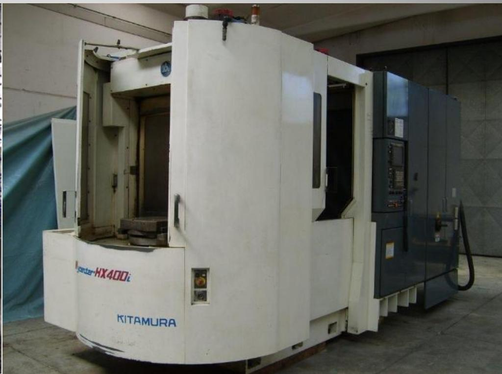
Рис. 5 Горизонтально-фрезерный станок с ЧПУ Kitamura HX400 -iF
