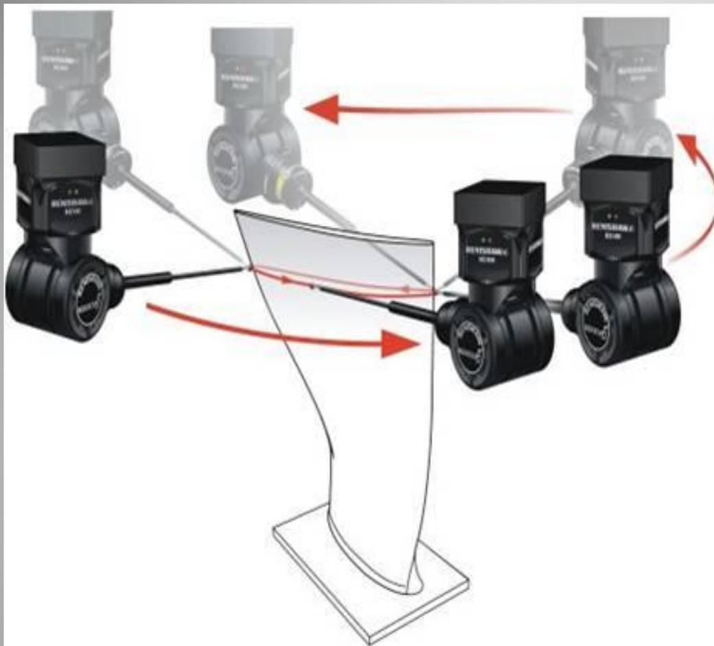
Рис. 33а Процесс измерения по траектории на КИМ
