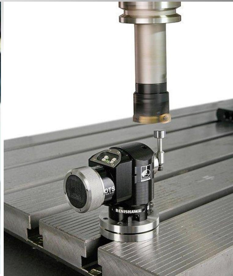
Рис. 30 Системы автоматической "привязки" инструмента
