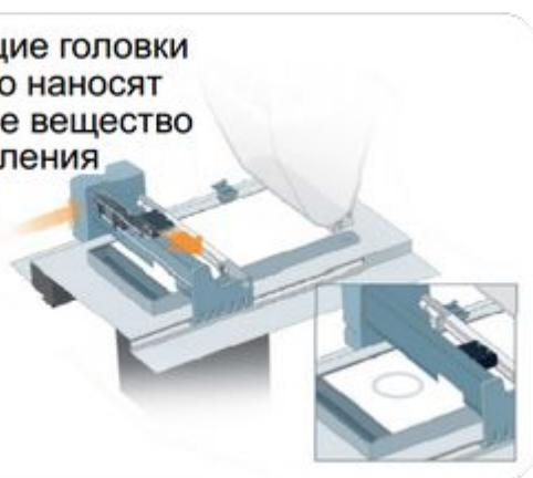
После подготовки модели печать в 3D-принтере происходит согласно технологии "3DP", запатентованной компанией Z-Corporation (теперь — 3D Systems). Это технология отличается простотой и эффективностью от других способов 3D-печати, в которых модели создаются путем УФ-отверждения жидкого фотополимера или из капель расплавленного термопластика. Суть этой технологии печати заключается в следующем:
