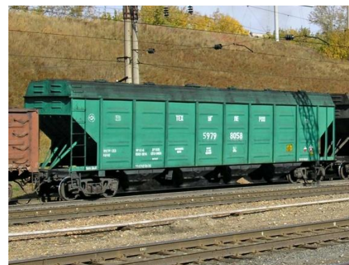
Модель 20-403 4-осный крытый вагон-хopper для гранулированного ТУ
