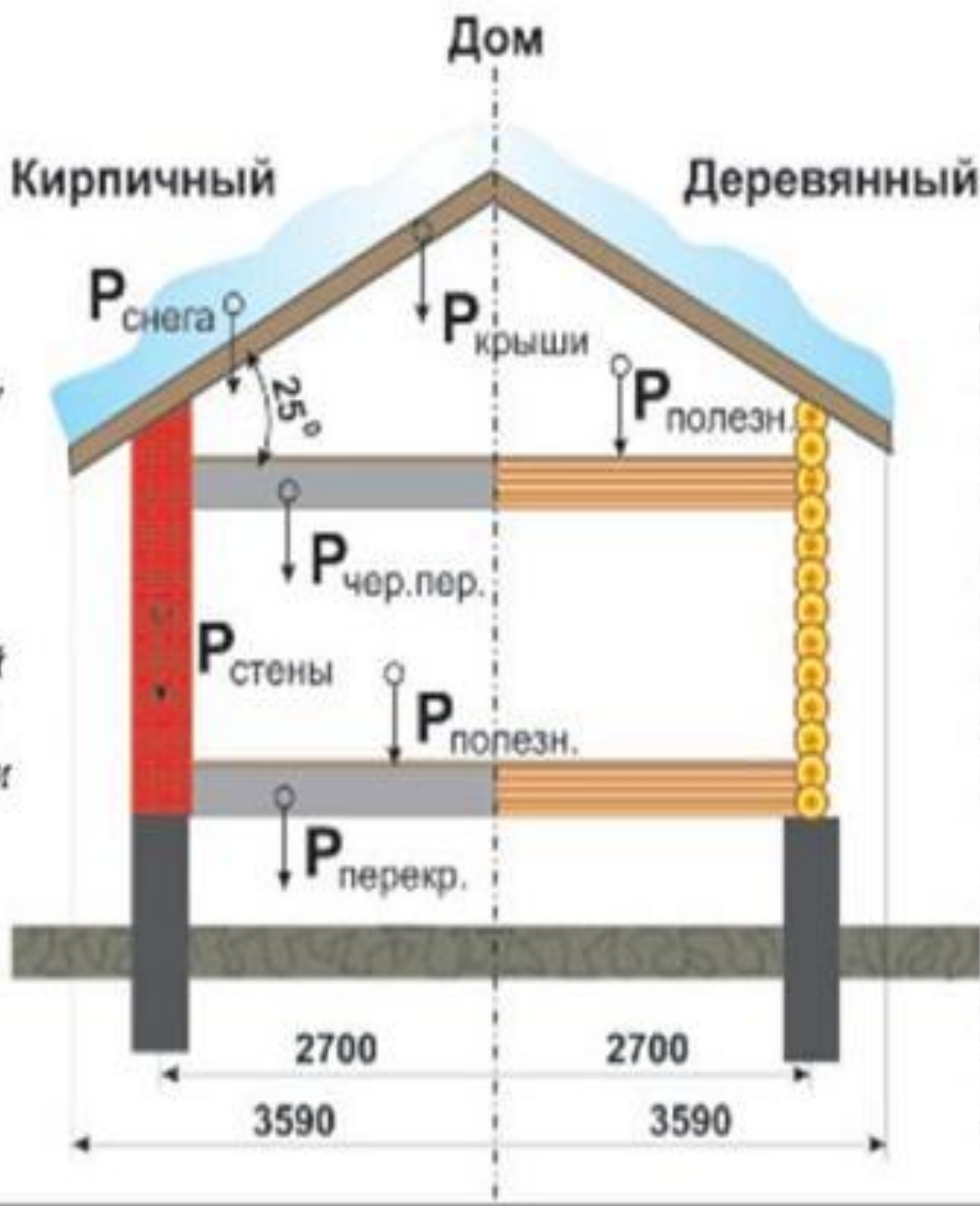
Нагрузки на 1 п.м. стропильной ноги
