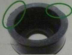
Deformaciones y Rebaba en Labio por desmoldeo
