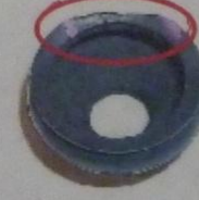
Arranque de material en labio
