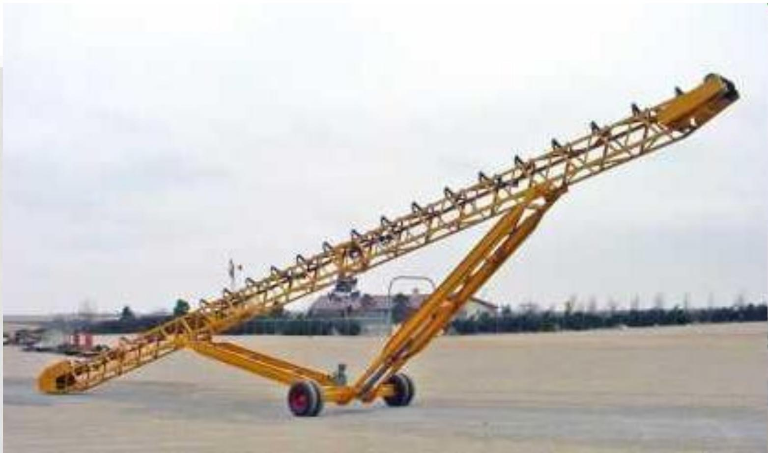
Конвейер ленточный передвижной
