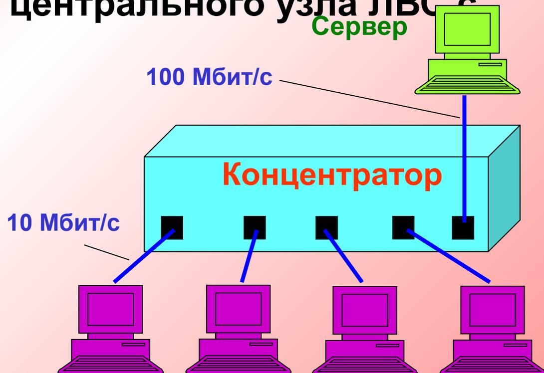
Концентратор может иметь **от 8 до 32 портов** для подключения ПК. Увеличение портов достигается объединением концентраторов в **единый стек**.
