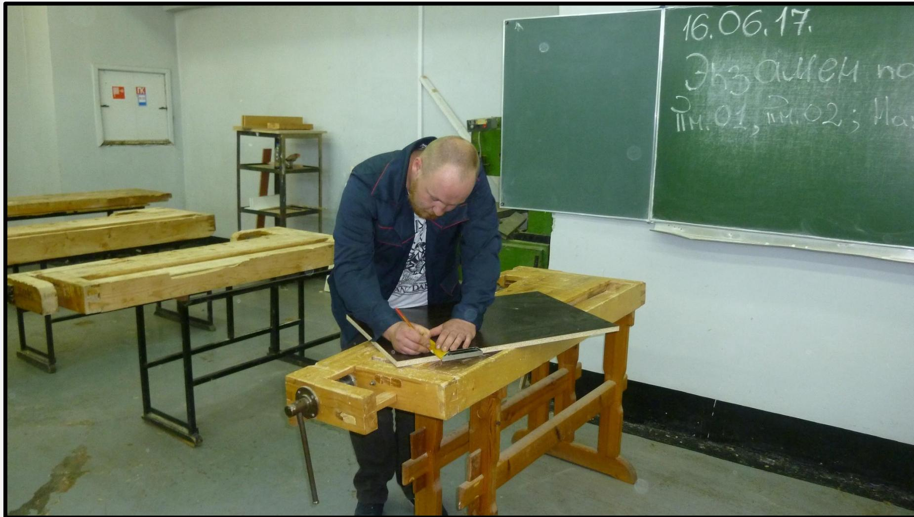
Операция разметки отверстий на заготовке
