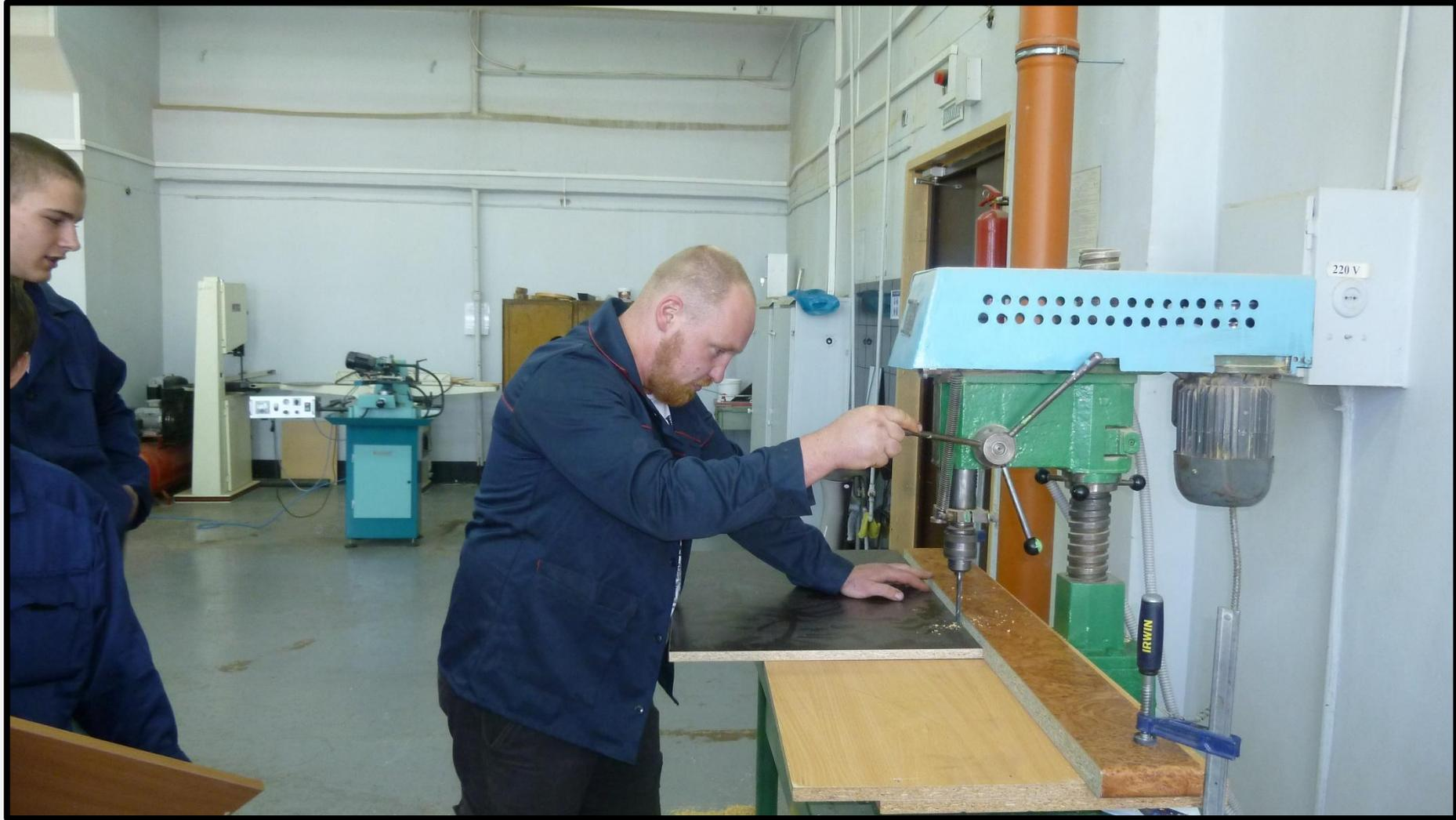
Операция сверления отверстий на сверлильном станке
