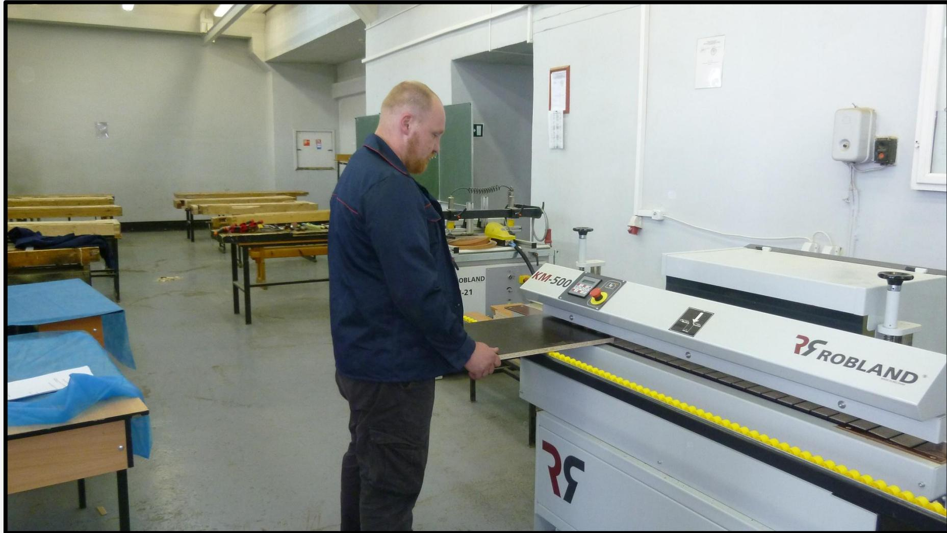
Операция облицовывания заготовки на кромочном станке
