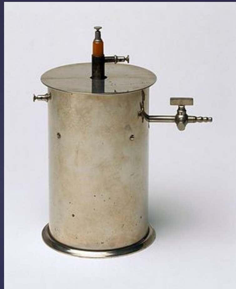
Іонізаційна камера, яку використовував П'єр Кюрі (1895–1900)
