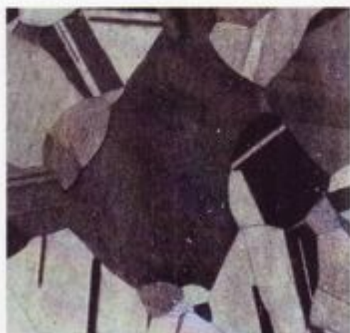
Структура однофазной латуни
