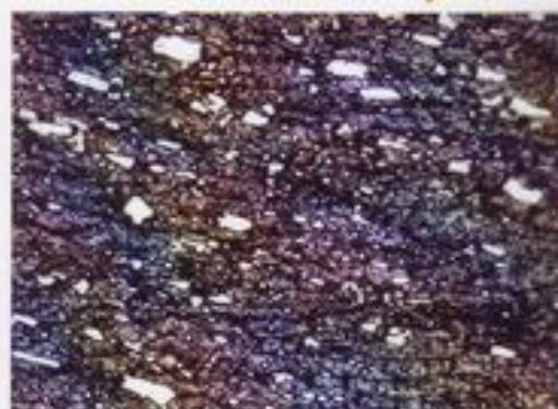
Структура стали X12M после закалки и отпуска
