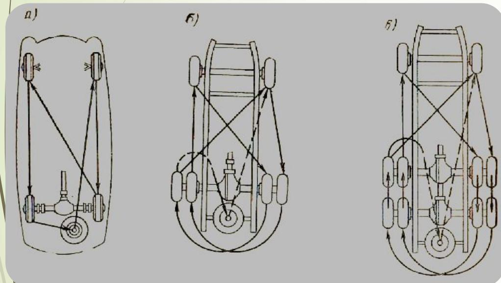
Передние и задние шины СДМ (автогрейдеров, погрузчиков, скреперов) изнашиваются неравномерно, поэтому при их смене необходимо обращать внимание на расположение рисунка протектора ведущих и ведомых колес.
