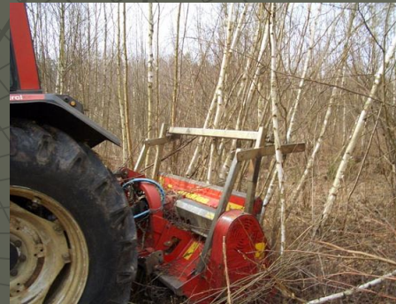
Косилка кусторез и ножницы кусторез
