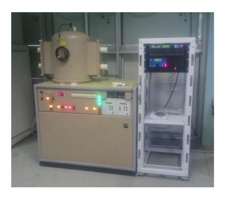
Напыление металлов и сплавов производят в среде инертного газа, как правило, *аргона*.
