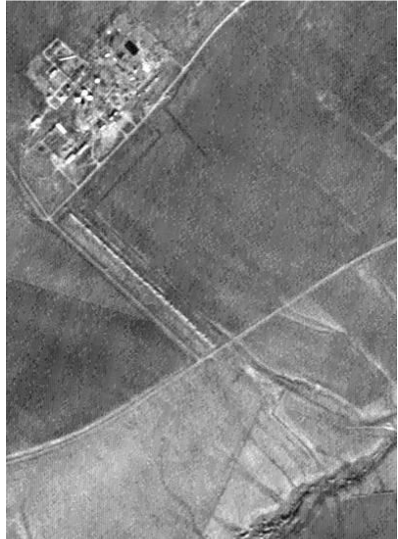
Фрагмент снимка IRS 1D PAN до и после проведения радиометрической коррекции методом устранения периодических шумов при помощи преобразований Фурье. Оренбургская область, окрестности г. Бузулук.
