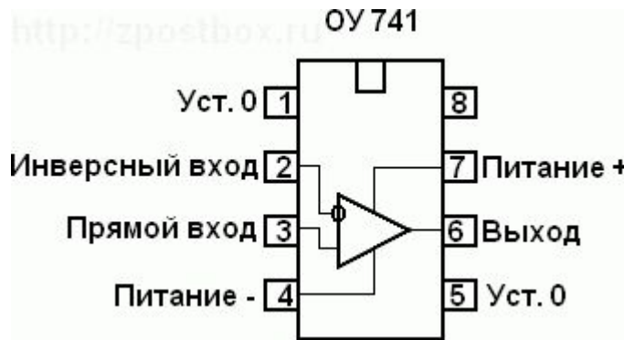
Цоколевка микросхемы ОУ - пример
