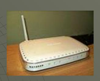
Обычно маршрутизатор использует адрес получателя, указанный в заголовке пакета, и определяет по таблице маршрутизации путь, по которому следует передать данные. Если в таблице маршрутизации для адреса нет описанного маршрута, пакет отбрасывается.
