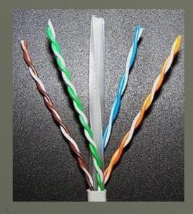
Витая пара (англ. twisted pair) — вид кабеля связи. Представляет собой одну или несколько пар изолированных проводников, скрученных между собой (с небольшим числом витков на единицу длины), покрытых пластиковой оболочкой.
