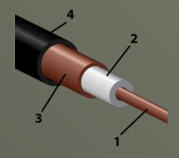
**Коаксиальный кабель** (от лат. *со* — совместно и *axis* — ось, то есть *соосный*; разговорное *коаксиал* от англ.*coaxial*) — электрический кабель, состоящий из центрального проводника и экрана, разделенных изоляционным материалом или воздушным промежутком. Используется для передачи радиочастотных электрических сигналов.
