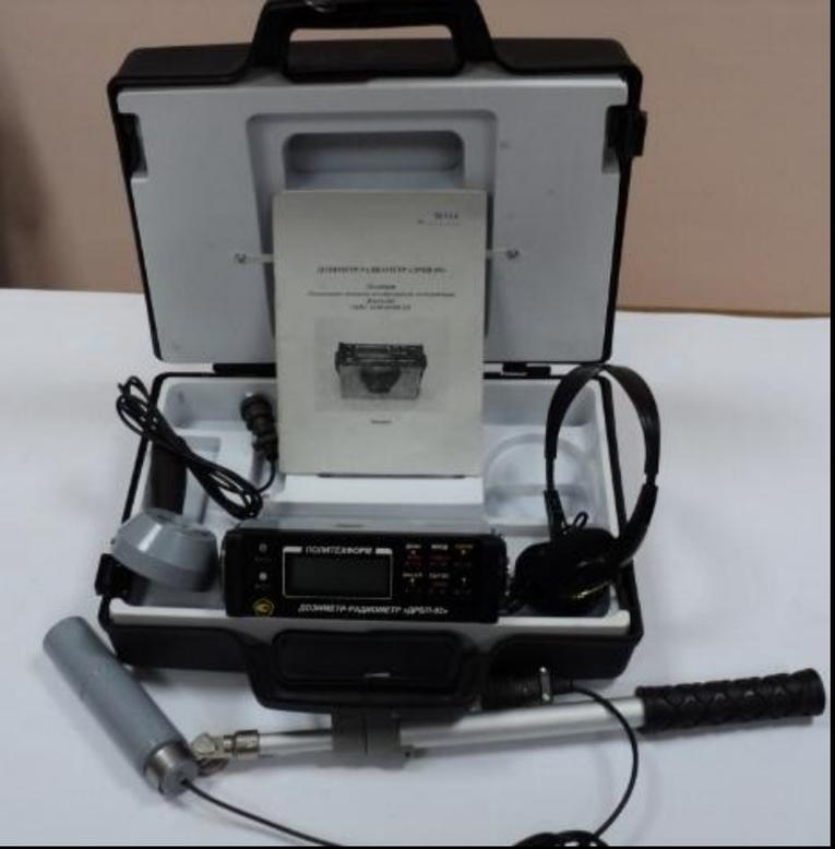
1. Измерение **мощности эквивалентной дозы (МЭД) рентгеновского и гамма-излучения** встроенными детекторами (**канал 1**) в диапазоне  $0.10-1000.0$  мкЗв/ч;
