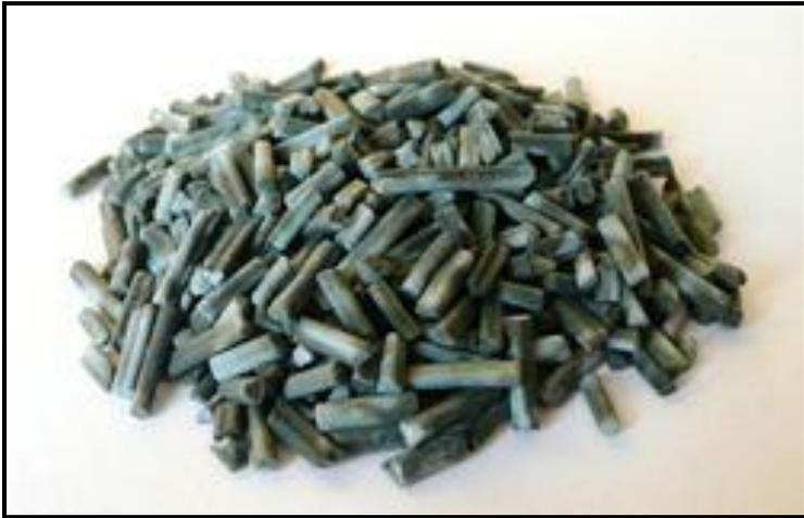
**Рисунок 3.** Катализатор гидроочистки дизельных фракций **НК-232** (Новокуйбышевский завод катализаторов)
