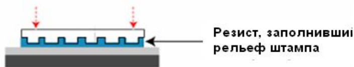
3. Опускание штампа и выдавливание рисунка
