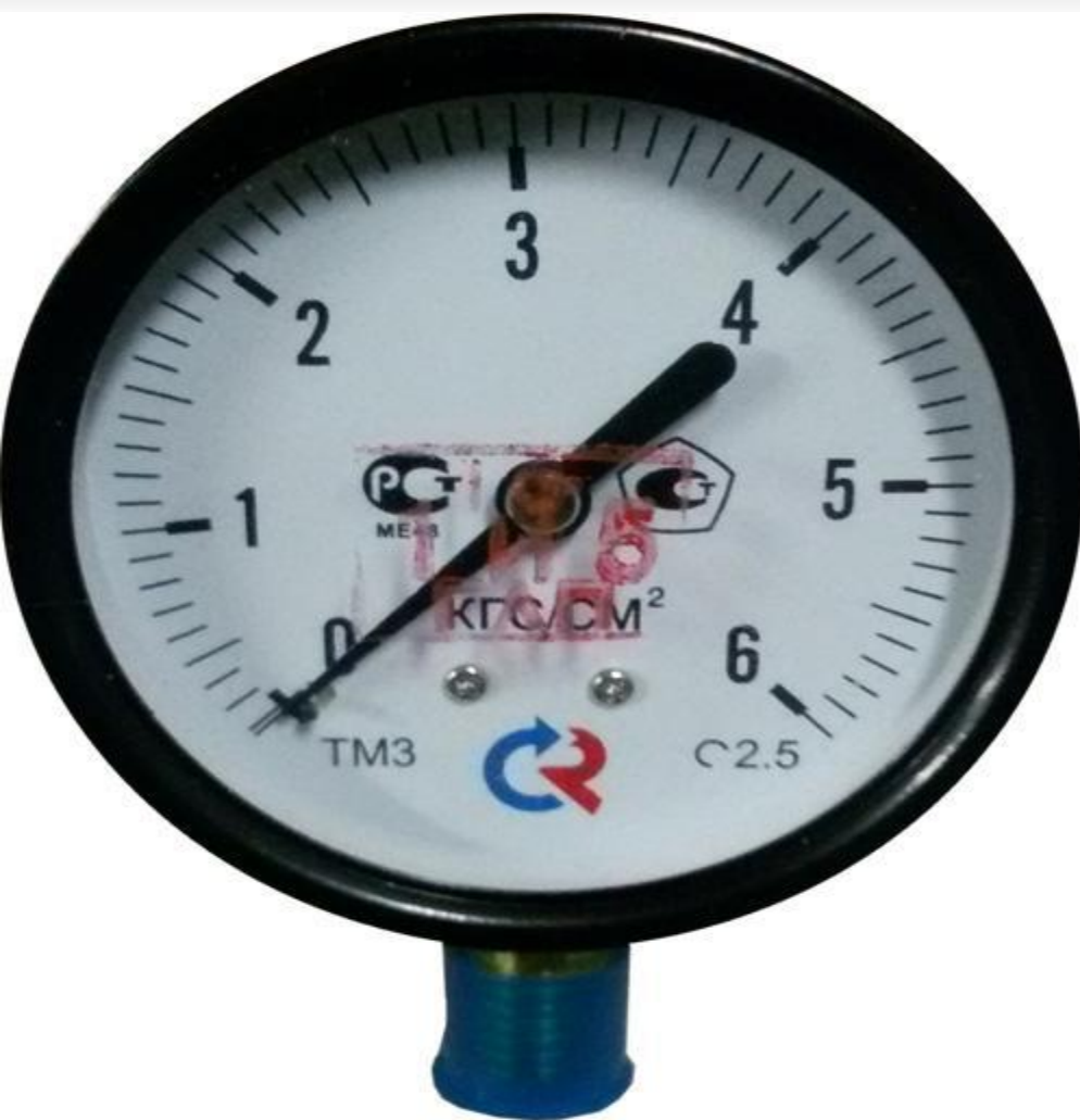
Манометр класса точности 2,5
