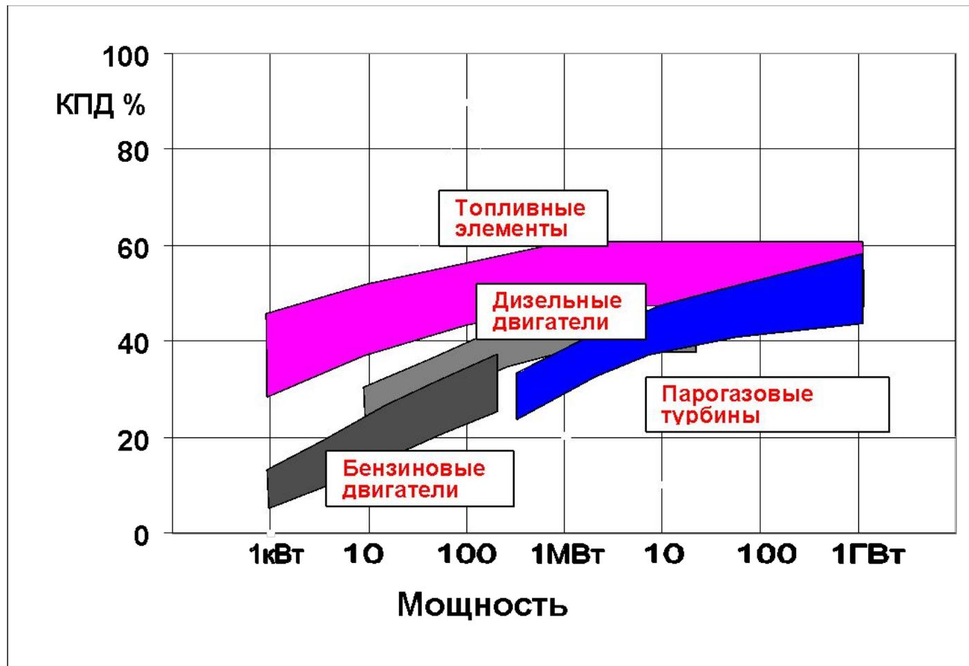
Зависимость КПД производства электроэнергии от мощности для энергоустановок различных типов. © В.Н.Фатеев
