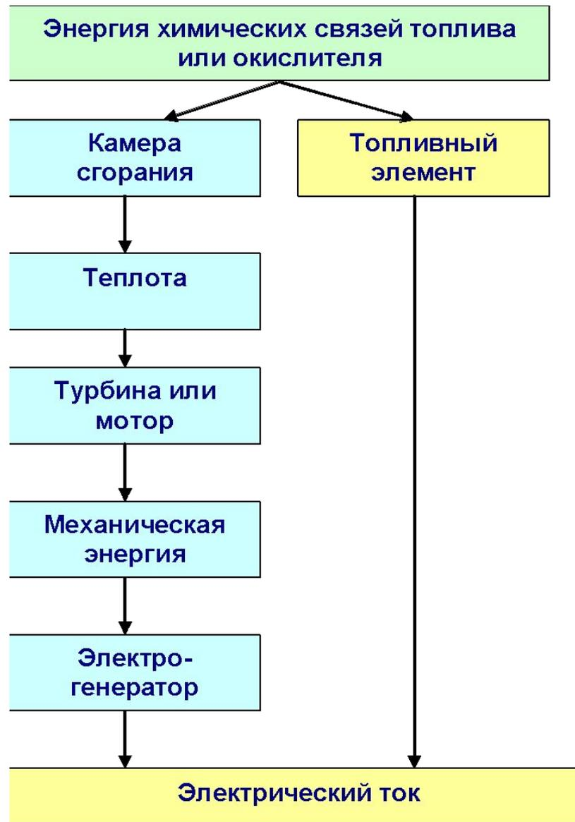
**Благодаря отсутствию низкоэффективного процесса сгорания эффективность топливных элементов может достигать 90%**
