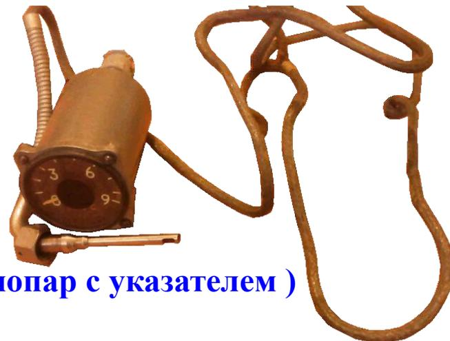
Предназначен для измерения температуры выходящих газов за турбиной двигателя **Аи-9В**
