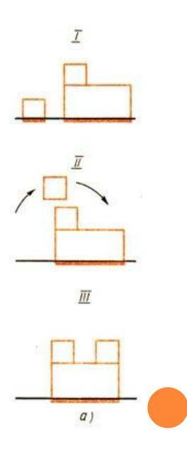
Способом надвижки устанавливают предварительно собранные в крупные блоки части здания, например блоки покрытий размером на ячейку зданий 12 х 24 м, 24 х 24 м, 24 х 30 м, нередко предварительно собранные конструкции технологических агрегатов.
