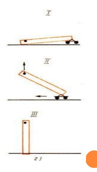
На рисунке приведены схемы технологической последовательности различных способов монтажа конструкций. Наряду с рассмотренными применяют также комбинированные способы
