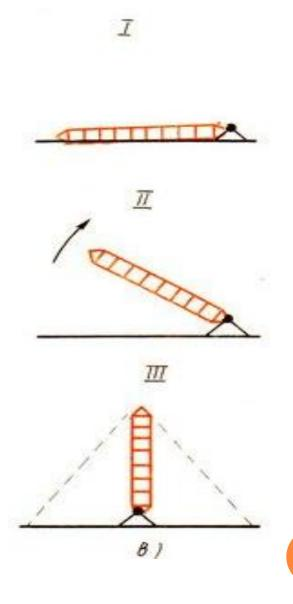
Способом поворота со скольжением монтируют тяжелые колонны. В этом случае краном при малом вылете стрелы приподнимают верхний конец конструкции, а нижний подтягивают к фундаменту лебедкой. Для уменьшения силы трения под нижний конец конструкции подкладывают полозья.
