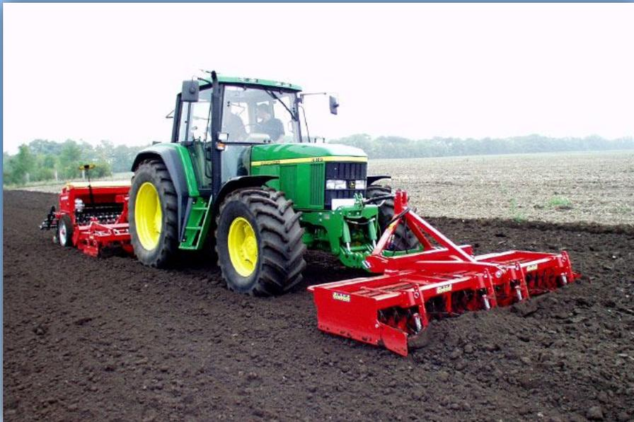
На передней навеске трактора – универсальный каток; на задней навеске - фрезерный культиватор + сеялка
