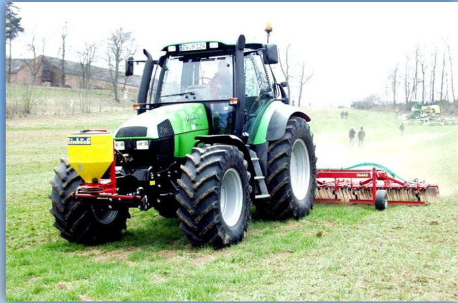
На передней навеске трактора – разбросная сеялка для промежуточных культур; на задней навеске - культиватор
