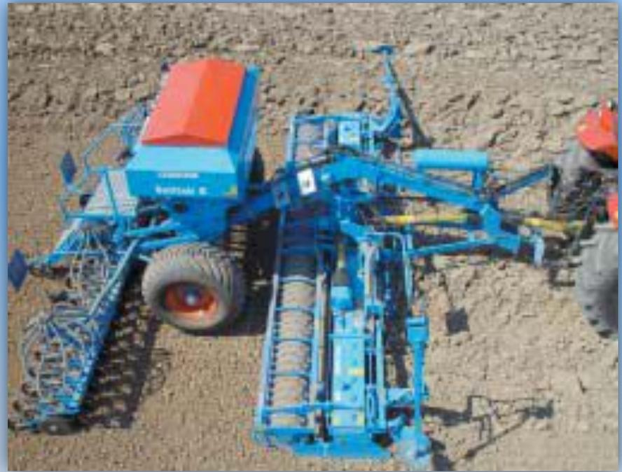
Последовательное соединение навесного фрезерного культиватора с прицепной сеялкой
