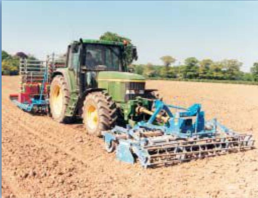
На передней навеске трактора - фрезерный культиватор; на задней навеске - сеялка
