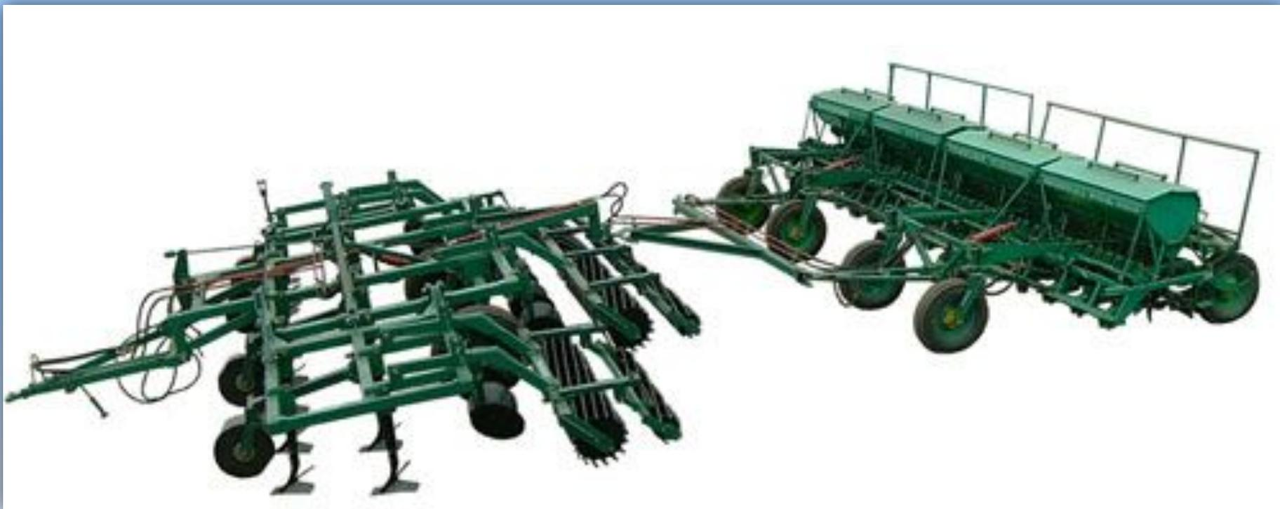
Сцеп почвообрабатывающего орудия **АПК-7,2** и двух сеялок **СЗП-3,6А**. Агрегат АПП – 7,2 применяется весной для посева по зяби или стерневому фону, посева озимых культур по чистому или раннему пару, посева по стерне.
