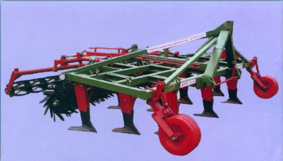
Культиватор-плоскорез универсальный **КПУ-3,6** предназначен для основной и предпосевной обработки почвы осенью или весной без оборота пласта на глубину 20 см, по стерневым и вспаханым агрофонам. За один проход выполняет: рыхление почвы, подрезание сорняков, мульчирование верхнего слоя. Имеет прицепное устройство для сеялки **СЗП-3,6**.
