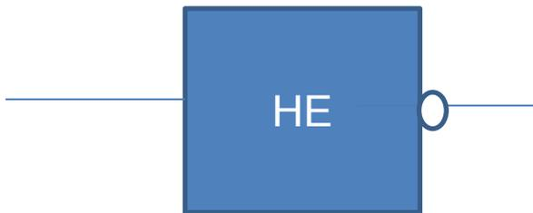
На западных схемах значок элемента «НЕ» имеет форму треугольника с кружочком на выходе. На отечественных схемах — прямоугольник с символом «1», с кружком на выходе.
