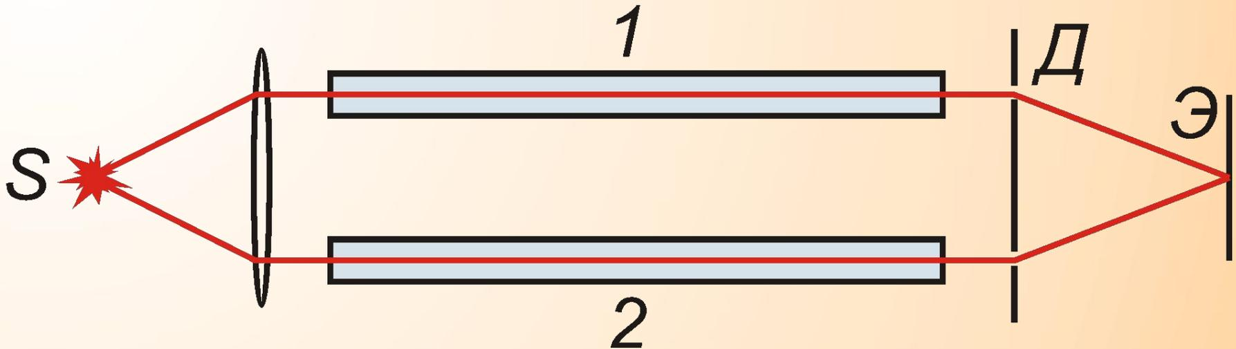
Определение показателя преломления  $n$  среды в одной из трубок.
