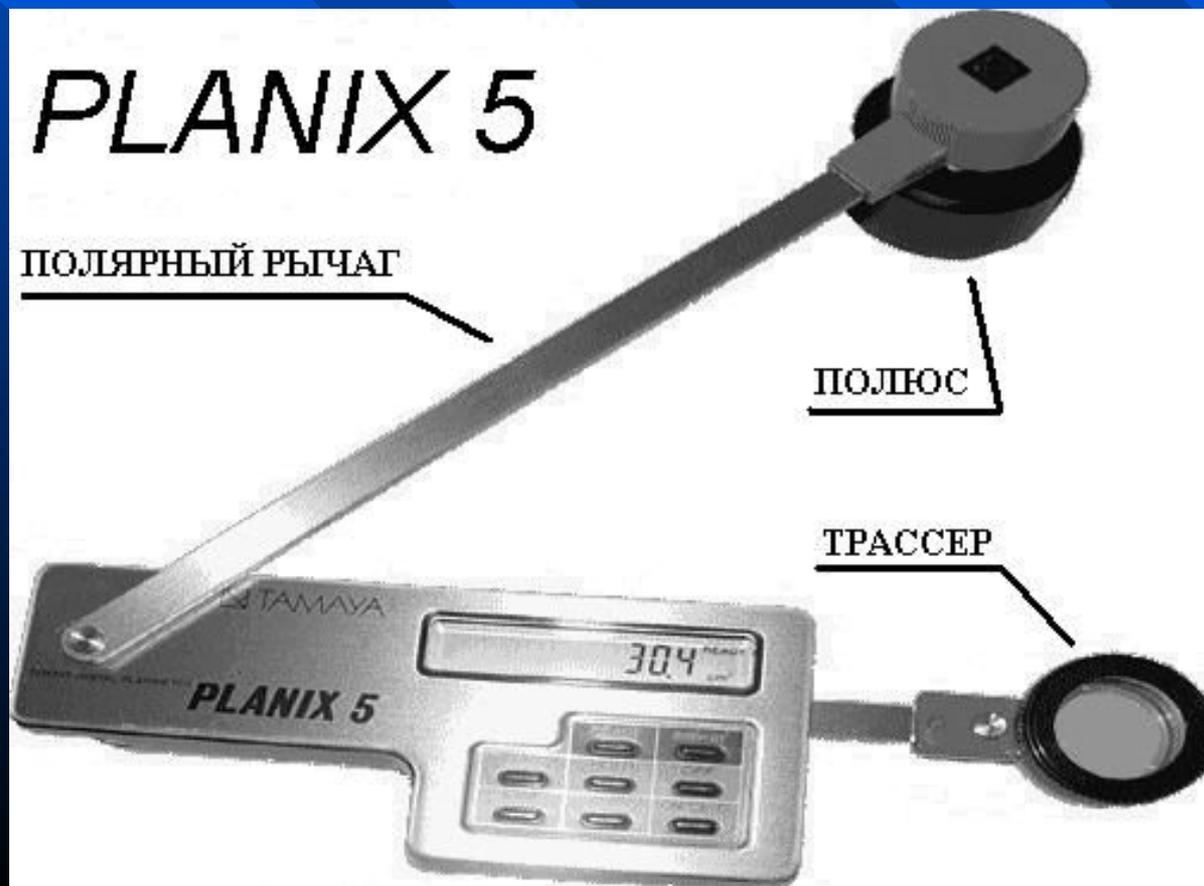
Площади целых землепользований определяют либо аналитическим способом, если по их границе проложены теодолитные ходы, либо планиметром и очень редко графическим способом.
