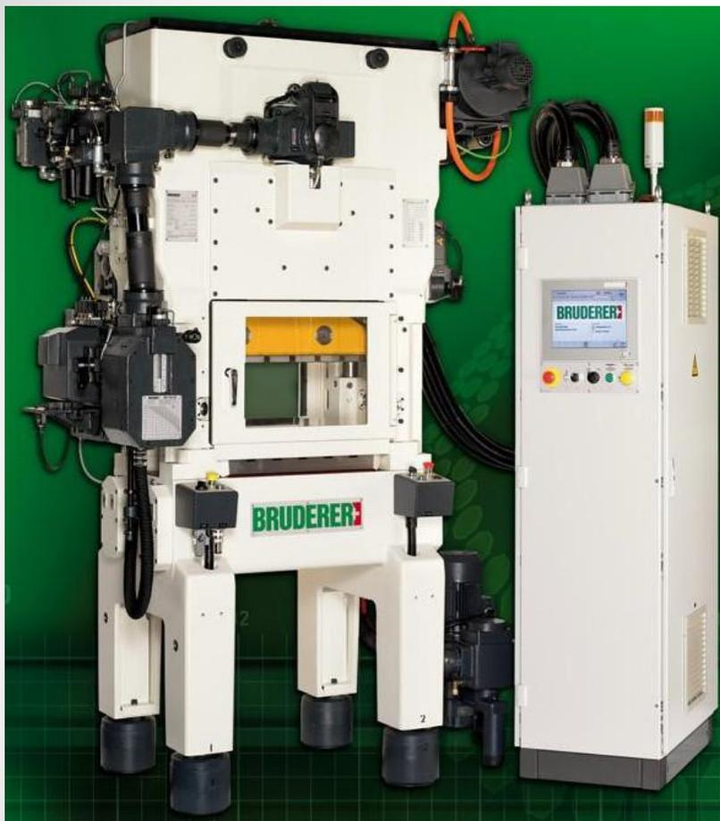
Высокопроизводительный штамповочный пресс с усовершенствованием системы балансировки масс и регулирования удара.
