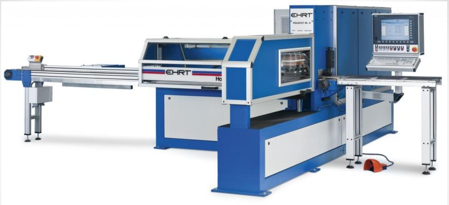
HOLECUT Professional Line служит обозначением для штамповочных станков EHRT с 3 управляемыми координатами ЧПУ. Все 3 координаты могут двигаться одновременно со скоростью до 60 м/мин. В новой версии SV могут совершаться до 120 движений штампа в минуту. Третья координата ЧПУ перемещает цилиндр точно над инструментом. Таким образом сводится к минимуму износ подшипников и инструментов, что гарантирует успешное применение станка на предприятии с многосменным режимом работы.
