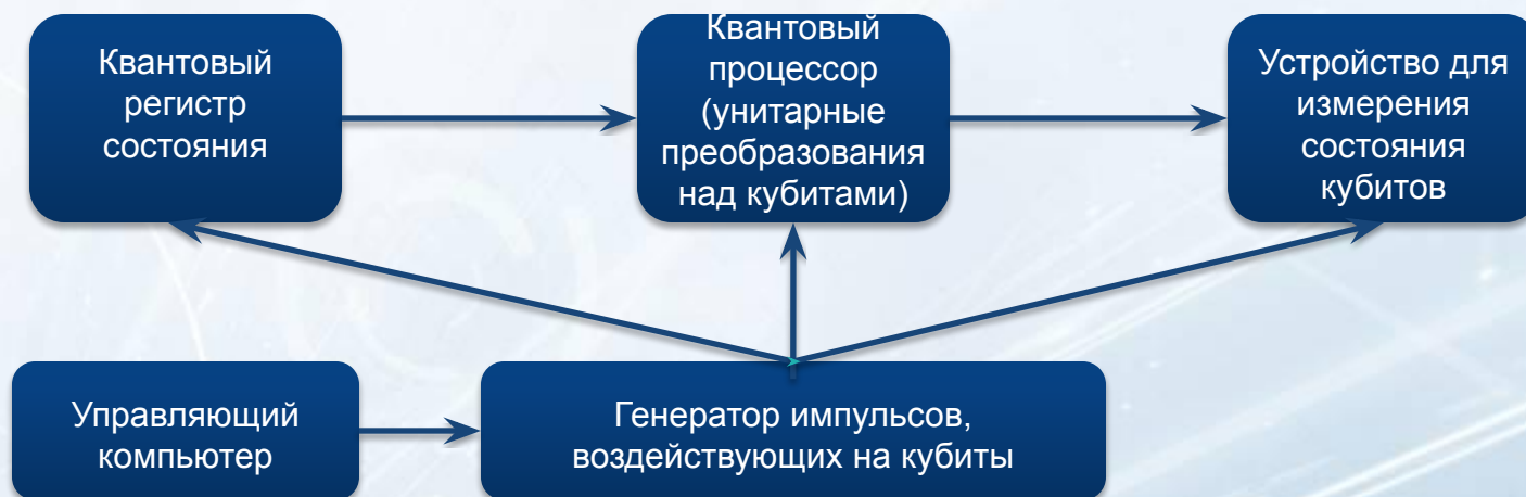
Схематическая структура квантового компьютера
