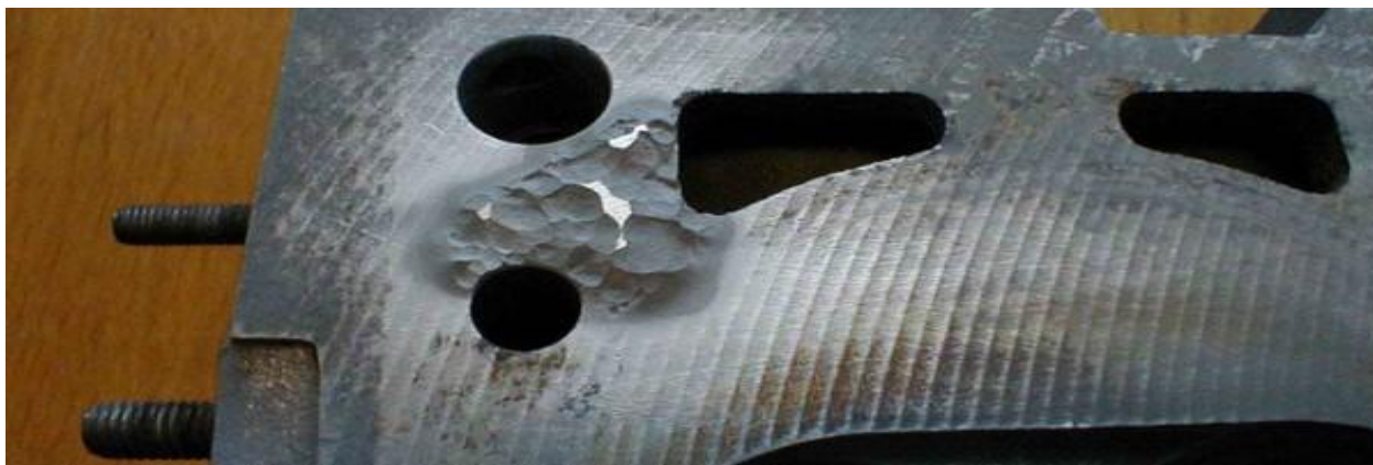
Рис.4 Коррозия ГБЦ – плохой антифриз начал “съедать” головку блока
