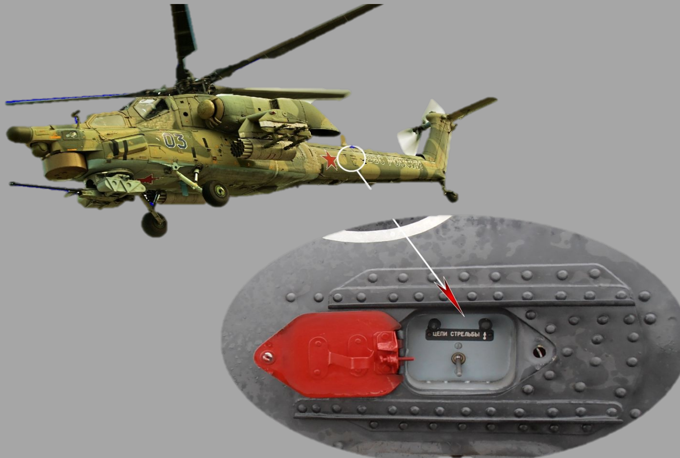
Предохранительный выключатель «ЦЕПИ СТРЕЛБЫ»
