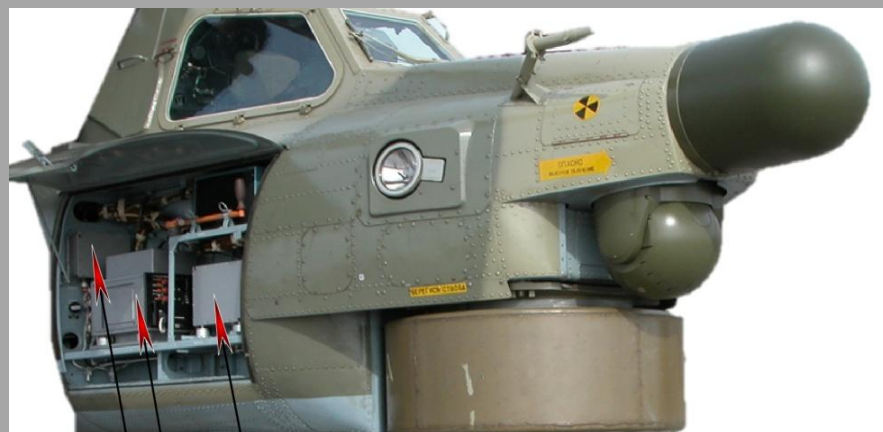
Электроблок лазерного дальномера ЭБ-ЛД. Электроблок гиросtabilизатора и привода ЭБ ГС и П-Т. Преобразователь ПР 115/400.
