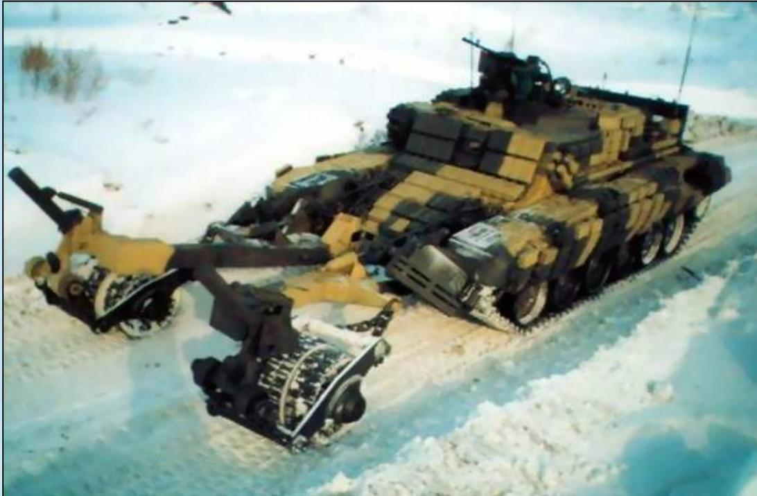
Предназначен для разминирования путей движения войск при сопровождении колонн.
