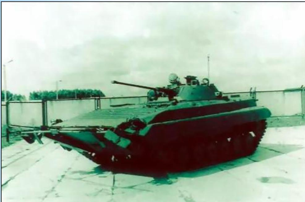
Предназначен для обеспечения преодоления танками противотанковых минных полей боевыми машинами БМП-1 и БМП-2
