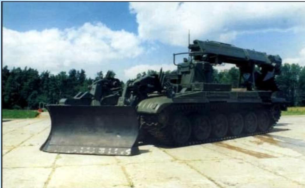
Предназначена для обеспечения продвижения войск через зоны разрушений в районах, подвергшихся ядерным ударам, и выполнения задач на радиоактивно зараженной местности.
