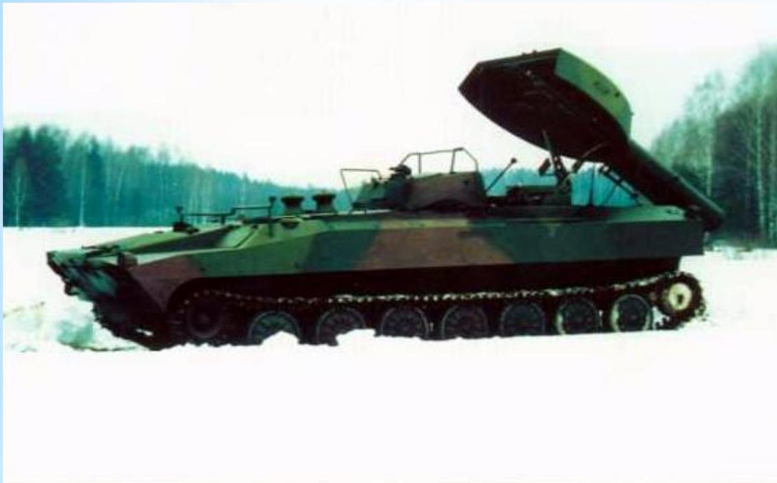
Предназначена для проделывания проходов в противотанковых минных полях взрывным способом.
