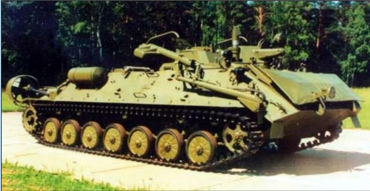
Предназначена для ведения инженерной разведки местности, путей движения войск, водных преград и минно-взрывных заграждений.
