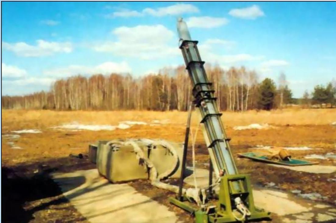
Предназначен для проделывания проходов в противотанковых минных полях взрывным способом.
