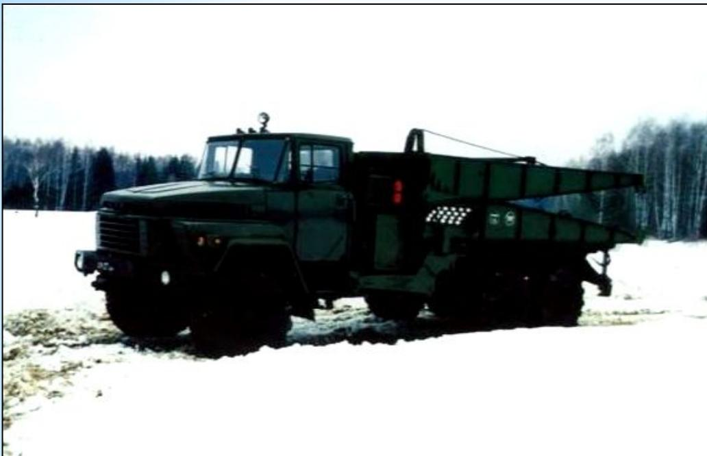
Предназначена для устройства многопролетных мостовых переходов через узкие преграды на путях движения войск.
