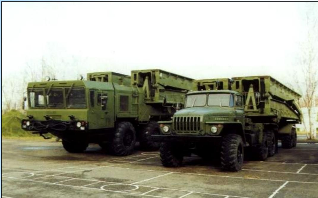
Предназначен для устройства мостовых переходов через узкие препятствия на путях движения войск.
