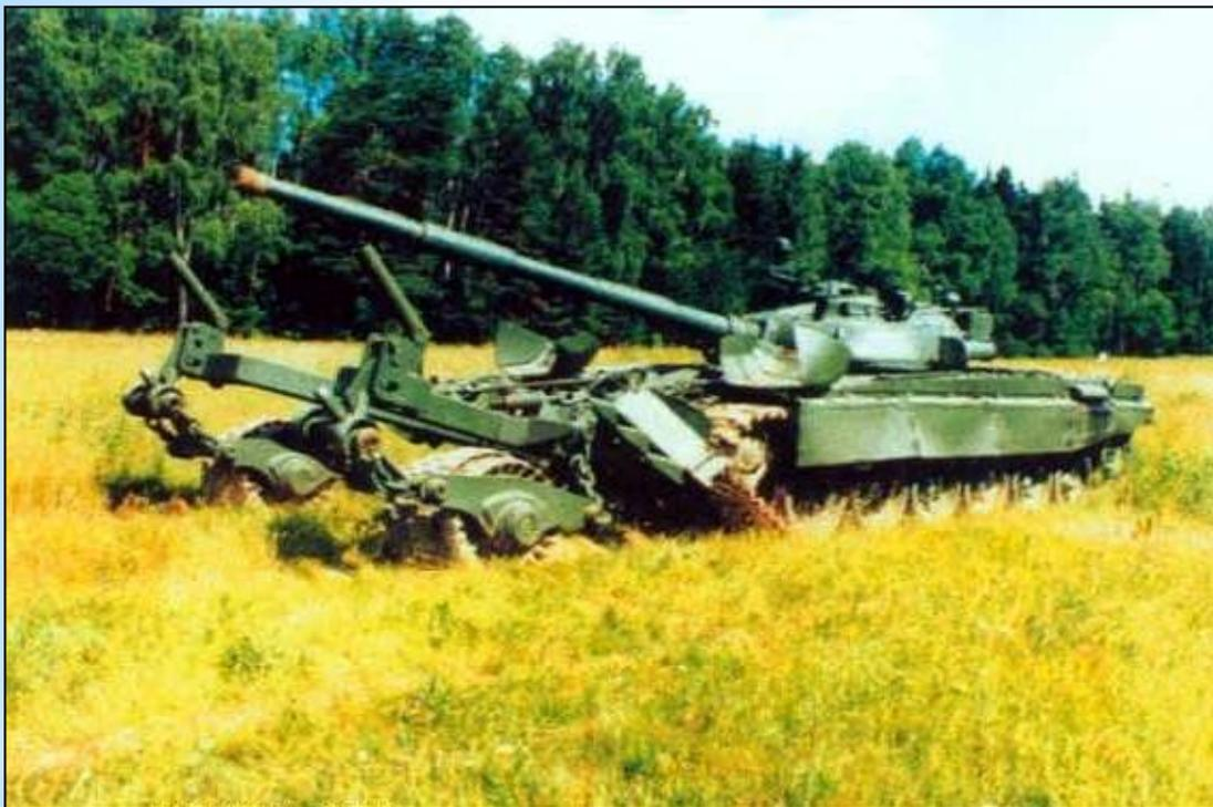
Предназначен для обеспечения преодоления танками противотанковых минных полей и проделывания в них колейных проходов.
