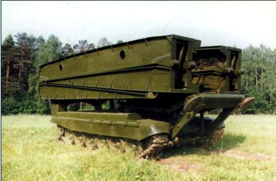
Предназначена для устройства мостовых переходов для пропуска танков и другой боевой техники через узкие препятствия.
